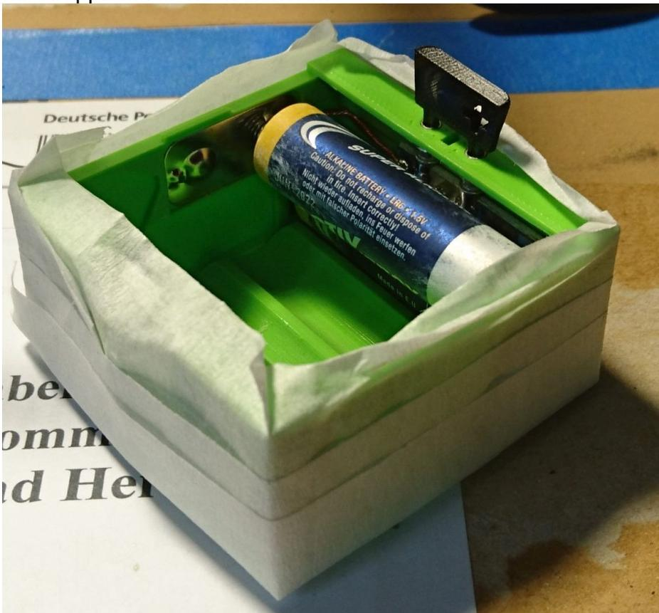
Im Gehäuse Kleber auftragen, wo die Platine hinkommt. Auch ein bisschen Kleber in die Vertiefungen für die Bundhülsen geben:
