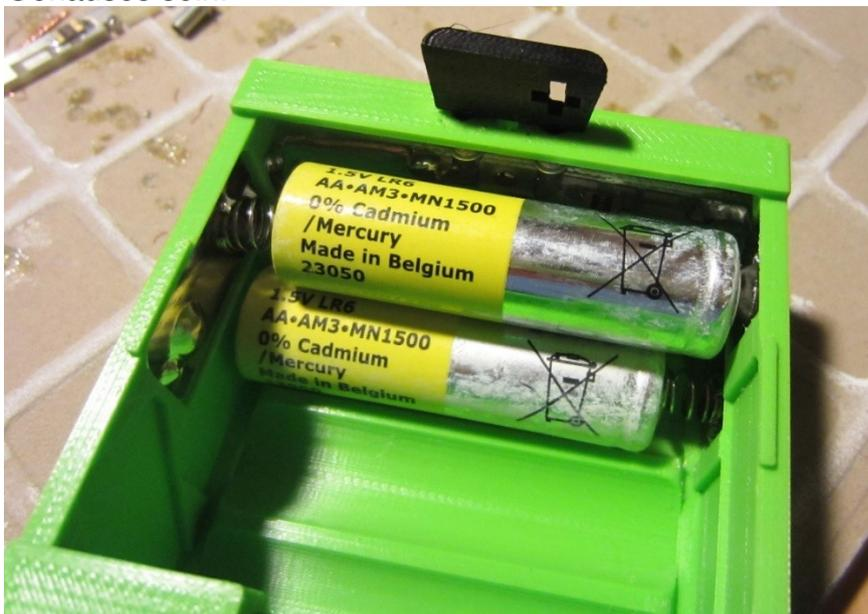
Wenn die Schraube sich nicht eindrehen ließ, die obere Batterie wieder herausnehmen und eventuell auf der Platinenoberseite vorhandenen Kleber abstreifen. Verpackungschips oder etwas zurechtgefaltete Wellpappe mit der oberen Batterie so einklemmen, dass die Platine gegen das Gehäuse gedrückt wird:
