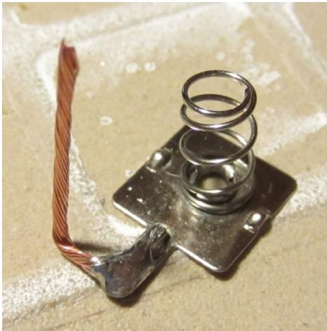
Nun wird der Pluskontakt eingepasst: Die Platine in die Montagehilfe einlegen. Rechts den Pluskontakt lose dranhalt (Zunge zeigt nach oben) und abschätzen an
