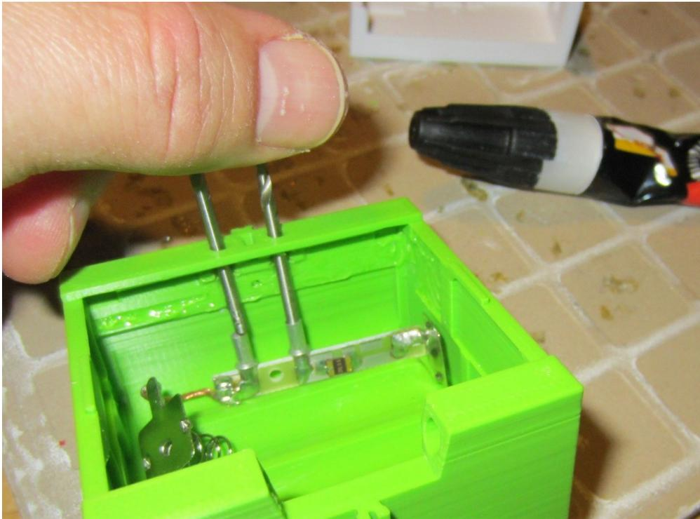
Mit den Nägeln als Führung die Bundhülsen nach oben durch die Löcher schieben und die Platine festdrücken.
