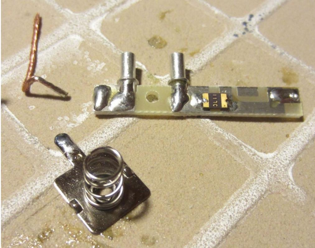
Die im vorigen Schritt zurechtgebogene Litze am kurzen Ende verzinnen. Das lange Ende darf sich nicht mit Lötzinn vollsaugen. Es muss für den Einbau ins Gehäuse biegsam sein. Kupfer leitet Wärme sehr gut. Die Litze mit Rundzange o.ä. halten.
