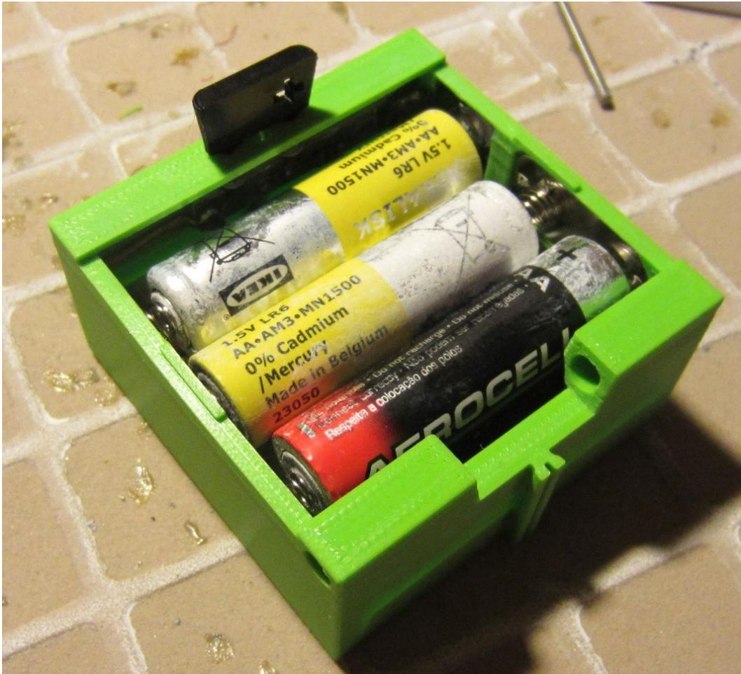
Die Federkraft der Batteriekontakte beult die Seitenwände des offenen Gehäuses aus. Den Deckel aufsetzen und mit der Kunststoffachse sichern. Den Bundhülenschutz eingesteckt lassen:
