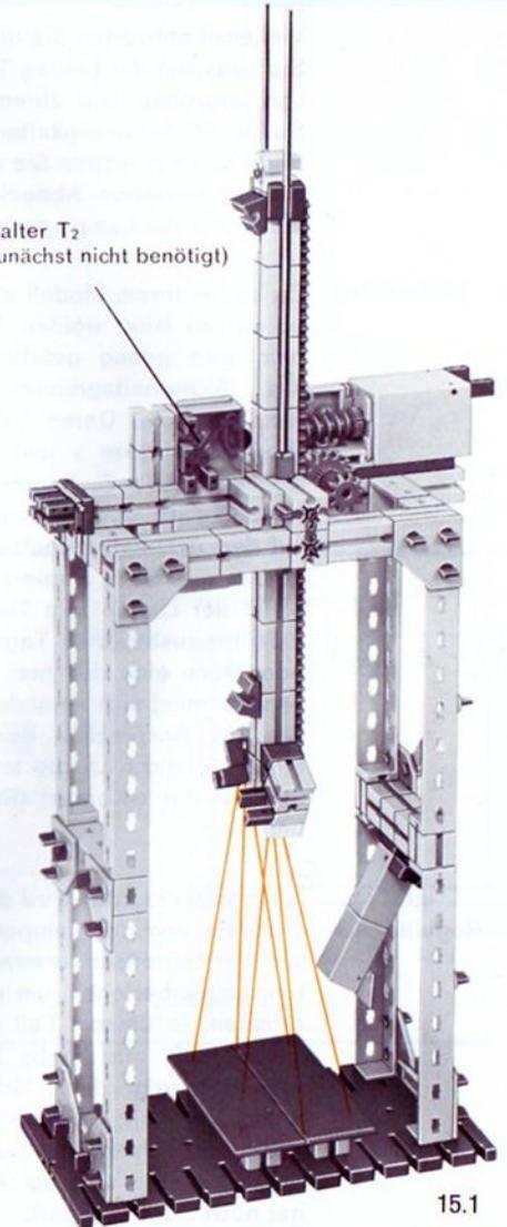
Vielleicht entwerfen Sie die Schaltung selbständig. Lassen Sie zunächst die beiden Taster des Modells unbeschaltet und erproben Sie Ihren Schaltungsentwurf ausgiebig. Sollte es Schwierigkeiten geben, sehen Sie bitte das Bild 13.1 nach. Achten Sie auf die Drehrichtung des Motors. Bei probeweisem Abdecken des Fotowiderstandes muß der Motor die Lampe nach unten fahren.
