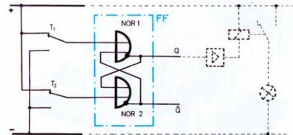
zustand von  $Z_{NOR_1}$ , sondern von  $Z_{OR}$  anzeigt. Dafür prüfen Sie mit dem gestrichelt eingezeichneten Schaltungsteil das Ausgangssignal am Ausgang Q der Schaltung.
