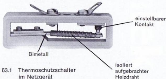
63.1 Thermoschutzschalter im Netzgerät
