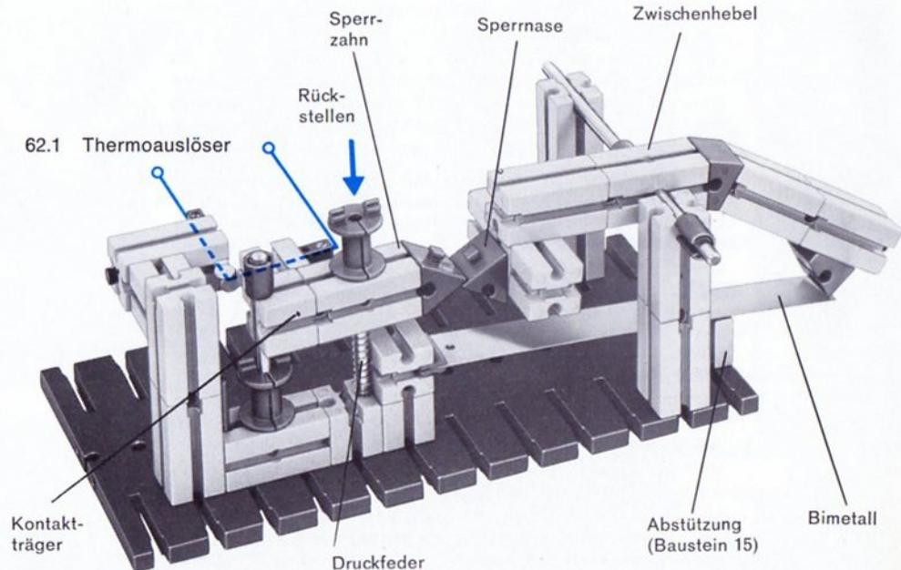
Wird das Thermobimetall, z. B. wegen eines in der Nähe entstehenden Brandes, stärker erwärmt, so biegt sich sein nicht eingespanntes Ende nach oben und nimmt den Zwischenhebel mit. Dessen Sperrnase gibt bei entsprechender Ausbiegung des Bimetalls den Sperrzahn frei. Der Kontaktträger gibt Kontakt und löst den Alarm aus. Das Alarmsignal bleibt gespeichert. Eine erneute Rastung des Kontaktträgers ist erst möglich, nachdem der Bimetallstreifen sich abgekühlt hat.
