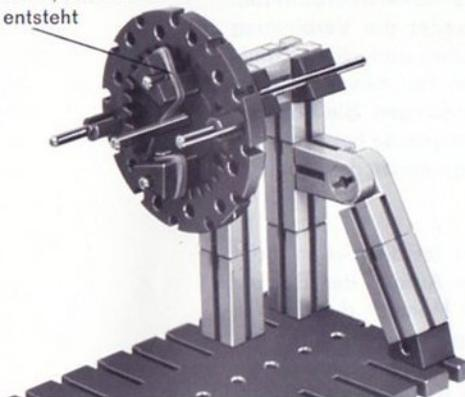
33.3 Gummiring eingehängt Innenzahnrad aufgesetzt
