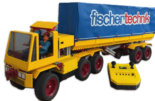
Abb. 3: Mit dem ftSwarmControl lassen sich die Funktionen des RC-Sets aus den 80iger Jahren exakt ersetzen, ohne die Optik der alten Modelle zu verändern
