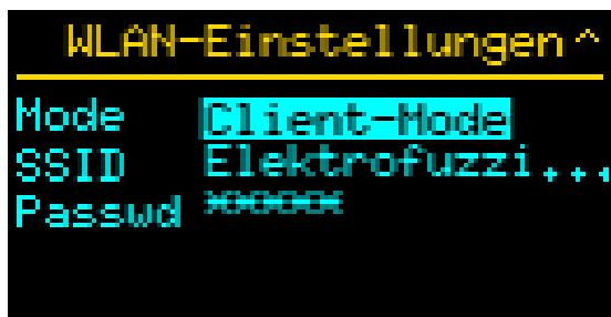
Abb. 4: Das WLAN lässt sich über das OLED-Display einfach einstellen
