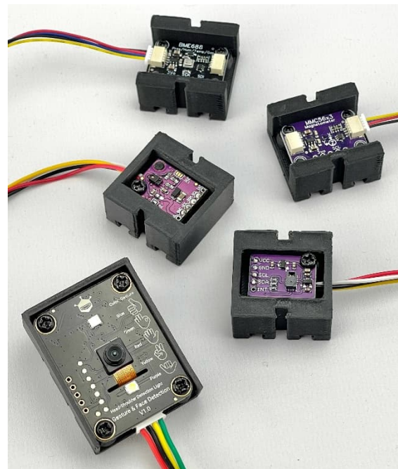
Abb. 1: Verschiedene Sensoren mit verschiedenen I 2 C-Steckersystemen
