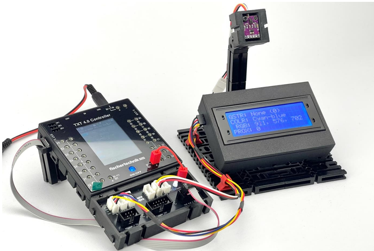
Abb. 14: Der I 2 C-Hub ermöglicht den Anschluss eines Bewegungssensors und eines LCD-Displays an den TXT-4.0-Controller
