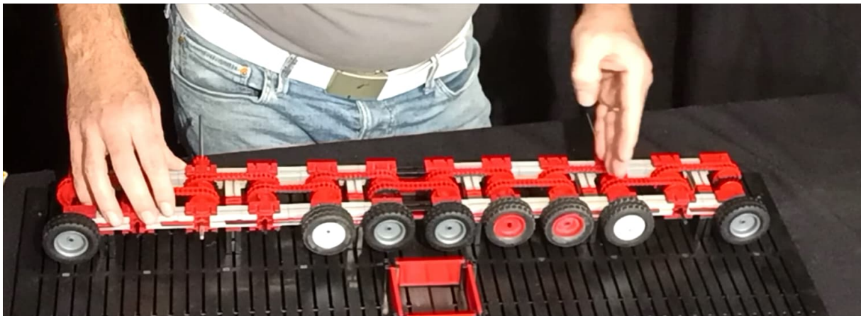
Abb. 6: Nach vielen Tests und einigen Berechnungen ergab sich, dass wir die Löcher des BS15 Loch auf 4,5 mm aufbohren müssen. Die Achsen werden bis auf den Bereich der Reifen abgeschliffen und die Naben mit Haftvermittler aufgebracht. Links die Version v8.1, rechts v8.3. Die Verbindung erfolgt mit einem Freilaufgrad. So sieht alles sauber aus.
