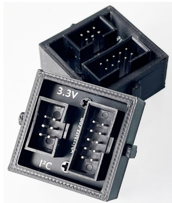
Abb. 3: Flachkabelmodul für 6-polige auf 10-polige I 2 C-Anschlüsse und umgekehrt
