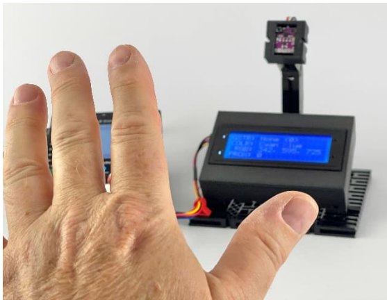
Abb. 11: Bewegungssensor APDS-9960 und LC-Display 2004A am TXT-4.0-Controller
