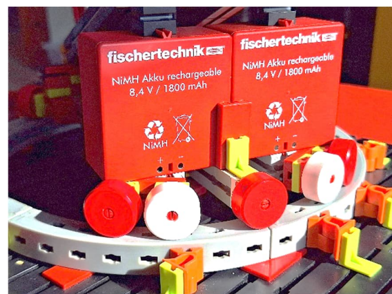
Abb. 12: Akku-Packs als Gegengewichte, im Original mit 250 t Sand gefüllt, und die Räder 23 auf der Drehscheibe bzw. einem Drehkranz, der auf der Grundplatte 1000 verankert wird
