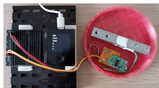
Abb. 7: Wägezelle an der Oxocard
