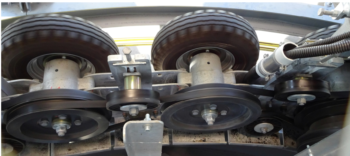
Abb. 1: Im Original sind die Räder in der Kurve ganz leicht gekippt. Gut zu sehen ist die Verbindung mit den Riemen. Rechts unten die Kupplung für die Ausgleichsstrecke.
