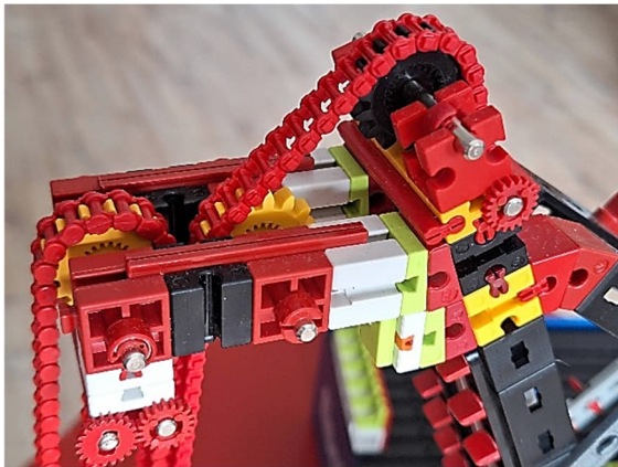
Abb. 3: Blick auf die „Flaschen“, d. h. die Umlenkrollen des Flaschenzugs mit Ketten
