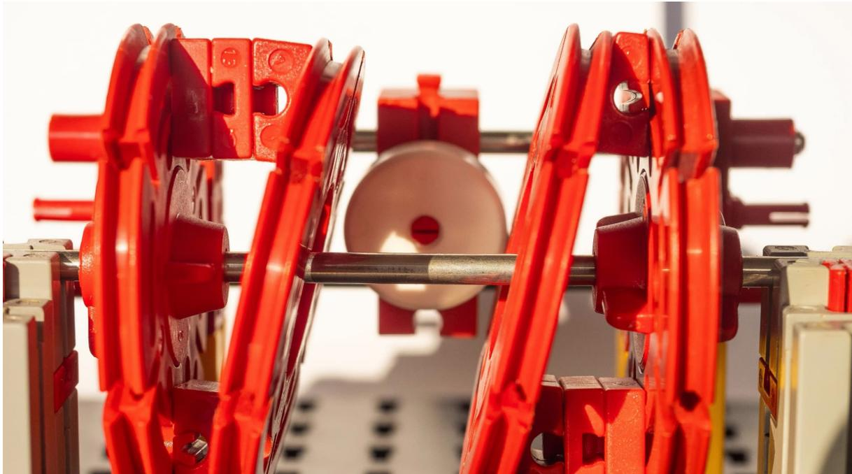
Abb. 2: Blick durch die schräggestellten Drehscheiben auf das zu bewegende Rad 14
