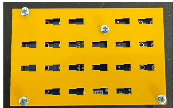
Abb. 4: fischertechnik-kompatible Montageplatte
