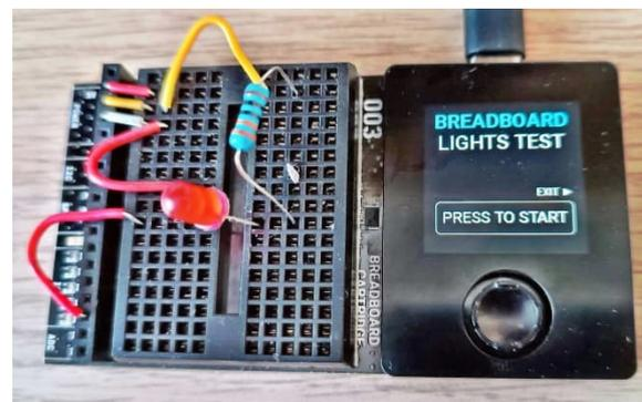
Abb. 2: Oxocard mit Breadboard-Cartridge
