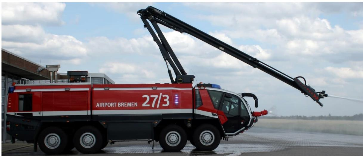
Abb. 1: Der Panther 8×8 mit HRET (Bild: Wikipedia © Geogast, zugeschnittene Version, Lizenz: CC BY-SA 4.0)
