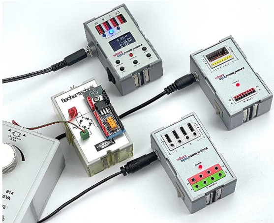
Abb. 2: Verschiedene Lösungen zur Bereitstellung einer 5V-Versorgungsspannung
