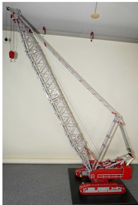
Abb. 19: Der KH1000 mit den beiden „9 m“- Auslegerteilen
