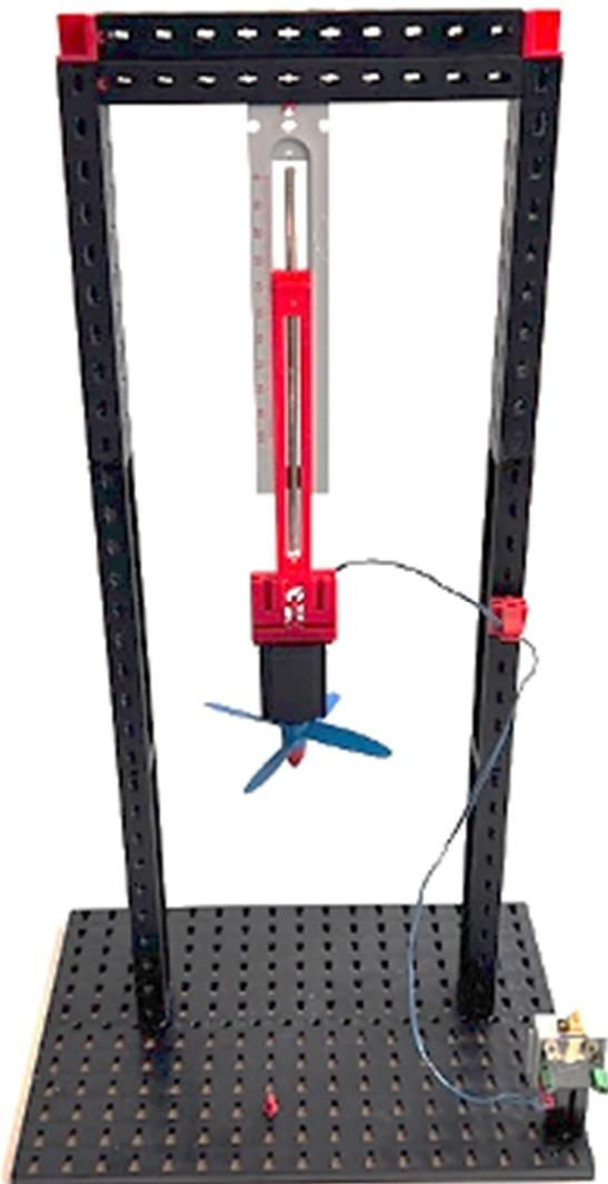
Abb. 11: Tensiometer-Messaufbau
