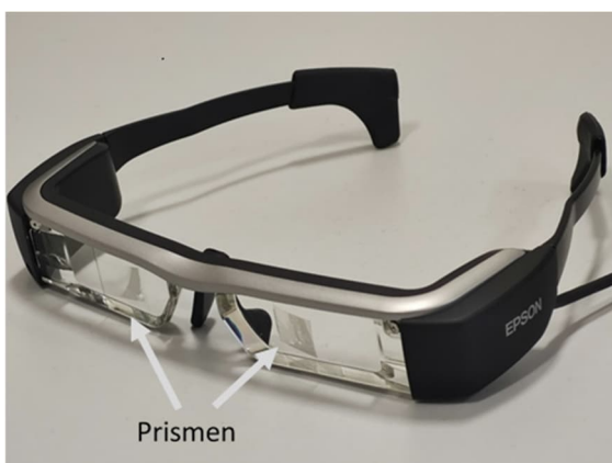
Abb. 7: Ein „optical-see-through“ AR Display: Epson Moverio mit Prismen
