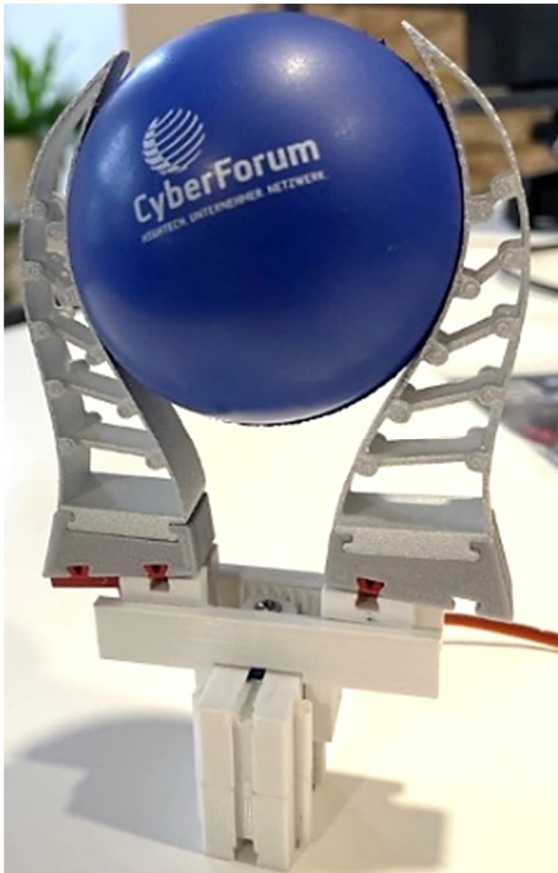
Abb. 12: Schräger Adapter im Mini-Servo-Greifer von Jan Hanson
