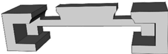
Abb. 8: Festo-fischertechnik-Adapter (gerade)
