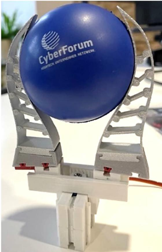
Abb. 12: Schräger Adapter im Mini-Servo-Greifer von Jan Hanson
