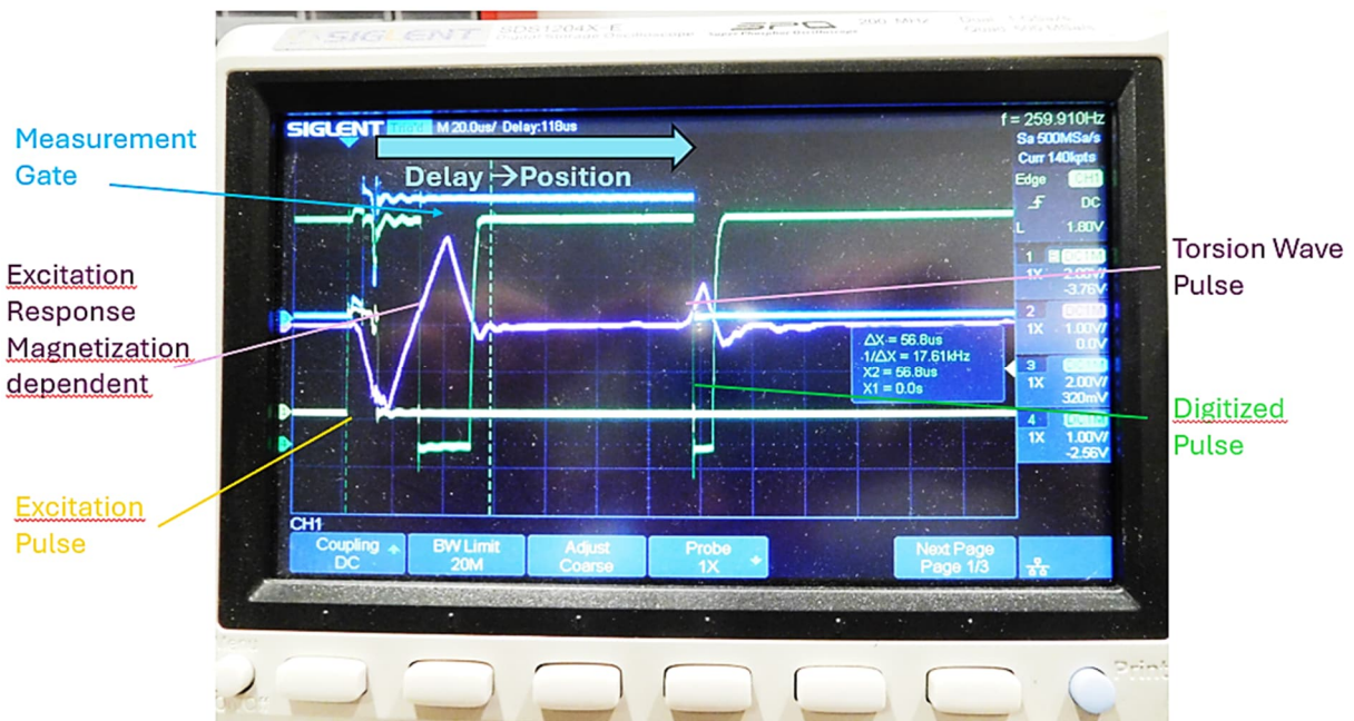
Abb. 11: Oszillogramm von Anregungsimpuls und Torsionswellen-Signal
