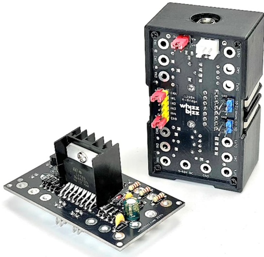
Abb. 6: L298 auf Platine in einem Silberling-Gehäuse
