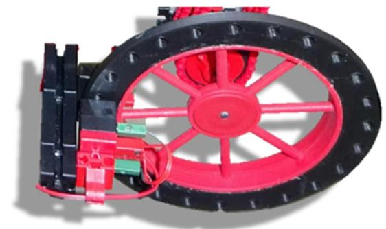
Abb. 3: Messrad zur Bestimmung der Seilgeschwindigkeit im Seilbahnprojekt
