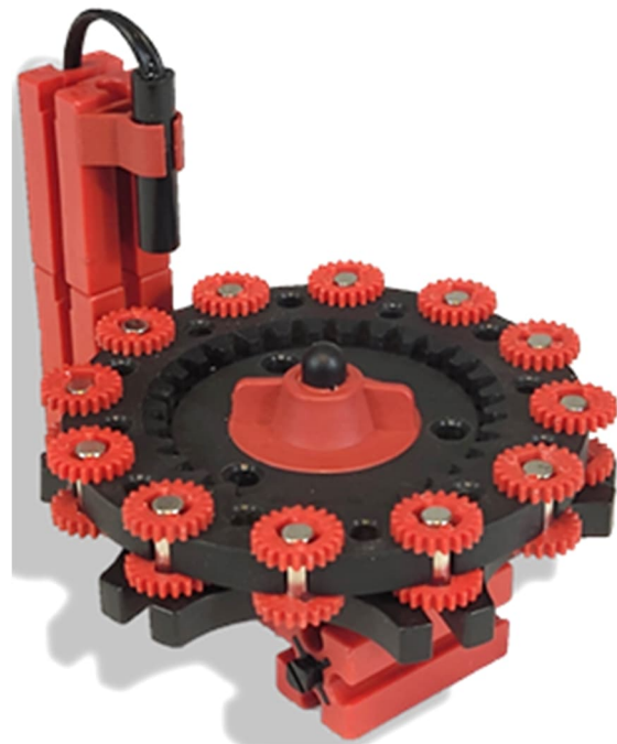
Abb. 8: Reedkontakt am Innenzahnrad
