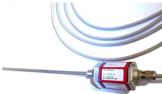
Abb. 1: Industrieller magnetostriktiver Wegaufnehmer der Fa. Temposonics für Hydraulikanwendungen mit RS-422 Interface. Zum Betrieb wird noch ein Positionsmagnet benötigt, der über den Sensor-Stab gleitet.
