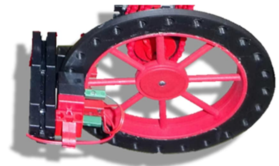
Abb. 3: Messrad zur Bestimmung der Seilgeschwindigkeit im Seilbahnprojekt
