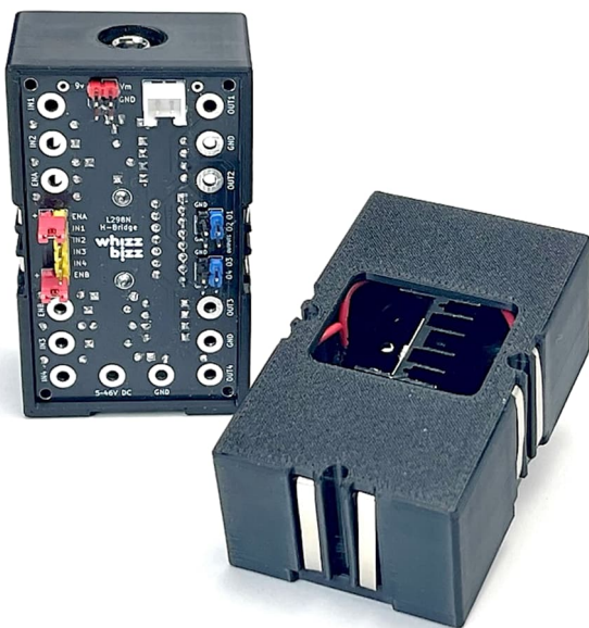
Abb. 9: Die Rückseite des Moduls mit einer Öffnung für den Kühlkörper
