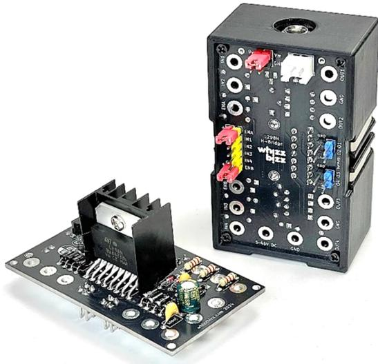
Abb. 6: L298 auf Platine in einem Silberling-Gehäuse
