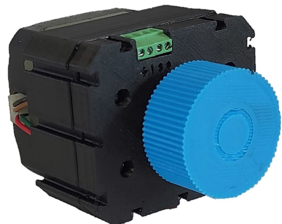
Abb. 11: Der ftKnob ist ein fertiger Drehregler
