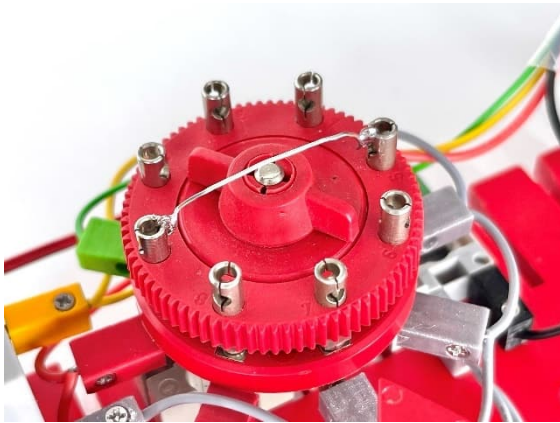
Abb. 4: Durchgelötete Verbindung, die unter den im Bauplan vorgeschlagenen Zeiger fallen kann
