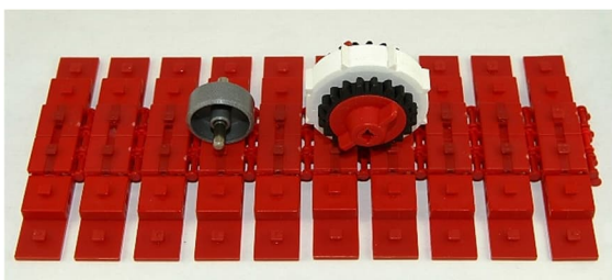
Abb. 26: Durch die leichte Verkürzung der Federnocken wurde Platz für die Zähne des Rades geschaffen. Die Z20 dienen für den Antrieb. Das 23-mm-Laufrad fällt noch immer in die Zwischenräume.
