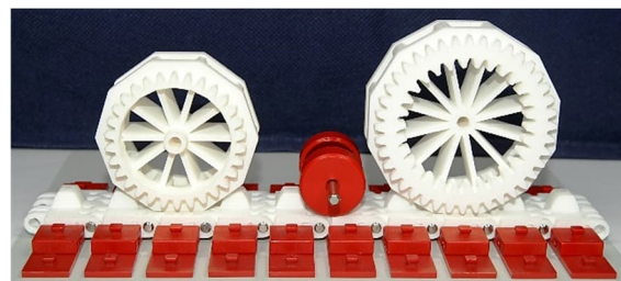
Abb. 34: Links das zehneckige Antriebsrad mit Z30-Zahnrad für den KH1000, rechts das zwölfckige mit Z40 und Z30 für den CC4800
