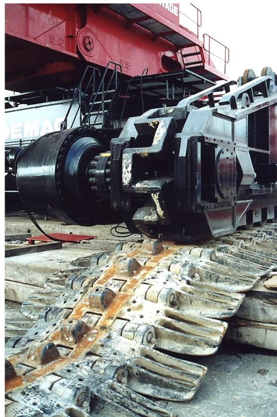
Abb. 24: Raupen und zwölfkantiges Antriebsrad des Demag CC12600, der nur einmal hergestellt wurde.
