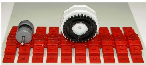
Abb. 28: Version 3 der Raupenkette mit dem zehneckigen Antriebsrad
