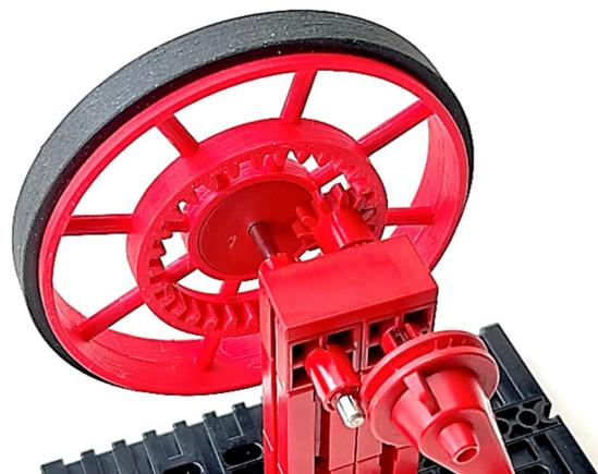
Abb. 8: Getriebe mit Innenverzahnung
