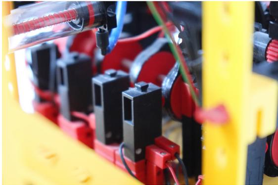
Abb. 23: Schaltnocken zur Steuerung des Presswerkes
