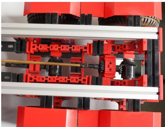
Abb. 13: Detailansicht Hinterachsen
