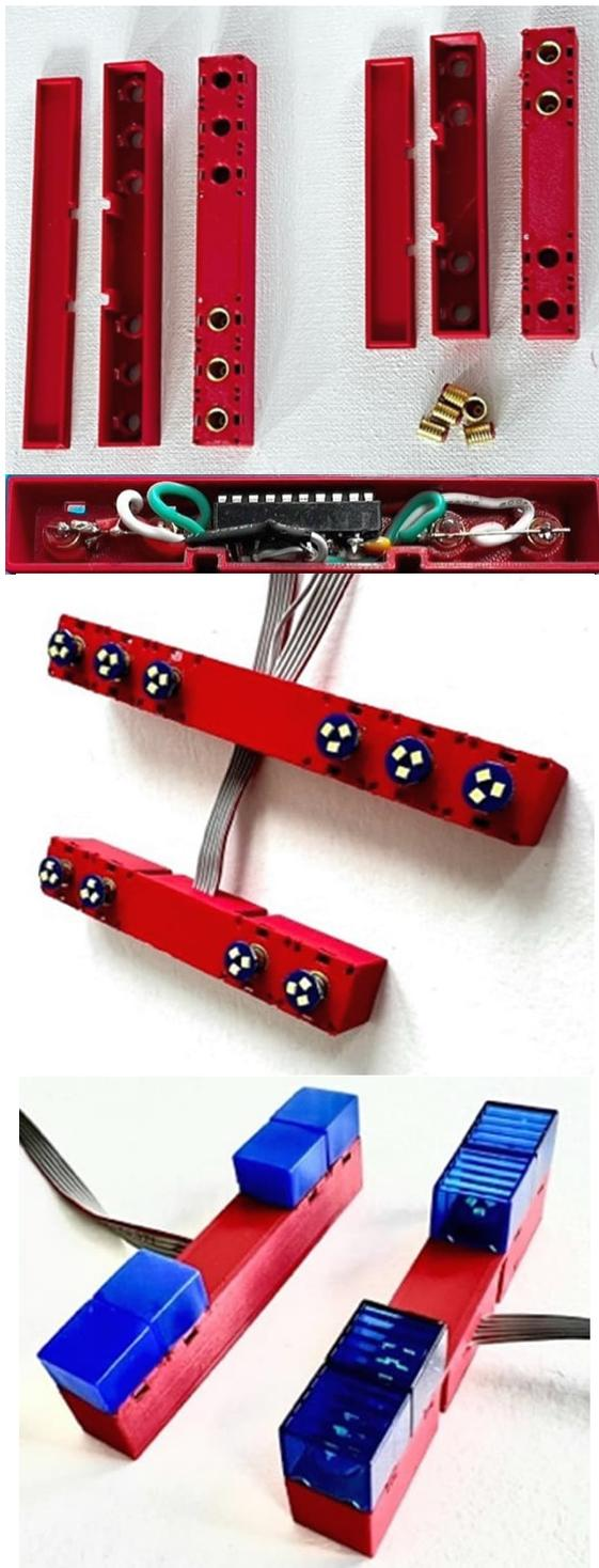
Abb. 6: 3D-gedruckte Leuchtleisten mit Verschraubungen und alten bzw. neuen Leuchtkappen
