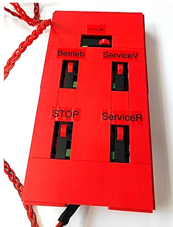
*Abb. 1: Wunderschön gebaut mit geflochtenen Litzen ist diese Servicesteuerung, mit der die Anlage in den Grundfunktionen auch ohne Steuerstand betrieben werden kann. Das dient als Backup und hilft beim Aufbau.*
