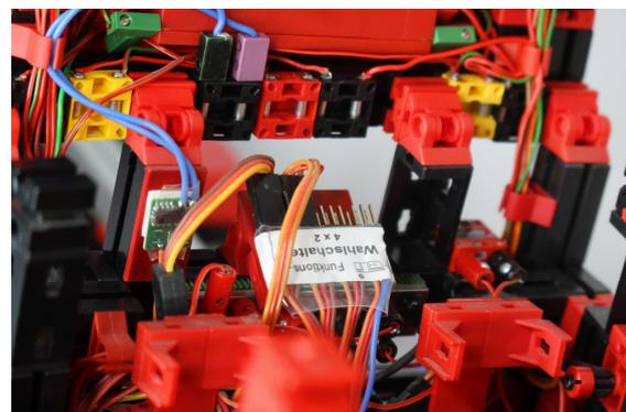
Abb. 4: Eingebauter Funktions-Wahlschalter, links daneben Schaltmodul für Brems- und Rückfahrscheinwerfer
