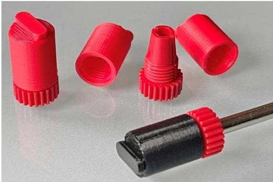
*Abb. 15: Selbstgedruckte Achsenverschraubungen*
