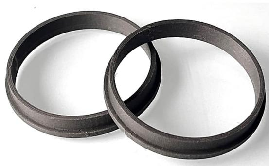
Abb. 24: Eisenbahnfelgen mit Flanschnaht
