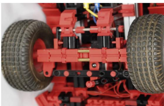
Abb. 14: Detailansicht Vorderachse
