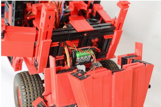
Abb. 8: Geöffnete Motorhaube mit MULTIswitch-Flexx-Baustein zur Steuerung der Lichtfunktionen
