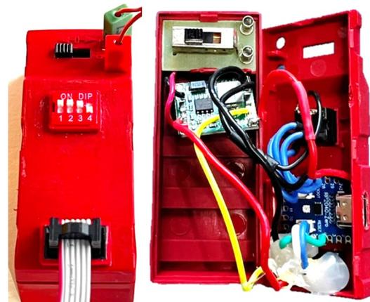
Abb. 5: Außen- und Innenansicht der Steuereinheit
