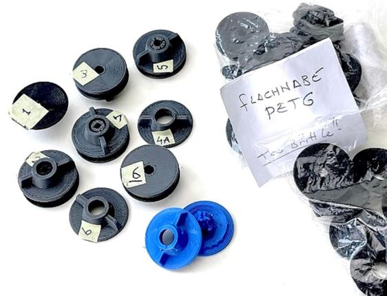
Abb. 10: Experimentieren mit dem Druck von Naben in Farbe
