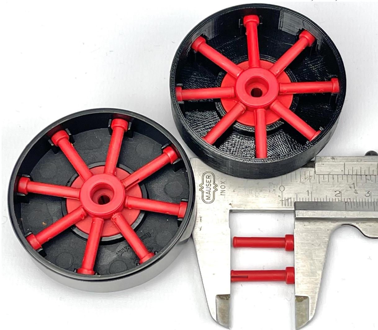
Abb. 13: Zwei Versionen von Rastachsen mit 20,5 mm (alt) bzw. 21,4 mm (neu, unten im Messschieber) Länge
