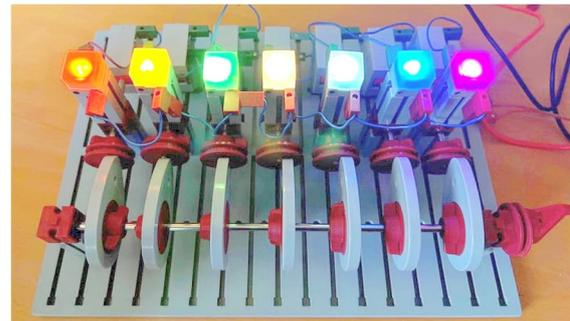
Abb. 12: Schraub-LED in den verfügbaren Farben (jeweils mit weißer Lichtkappe)
