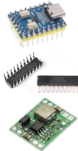
Abb. 1: RP2040-Zero (Microcontroller), TPIC6B595 (Schieberegister) und MP1584EN (Spannungswandler)
