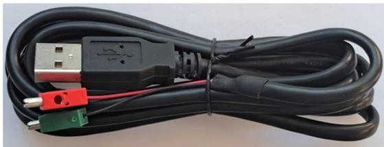
Abb. 9: Das USB-Kabel mit fischertechnik-Steckern aus dem Ergänzungsset „Versorgung“ 75003 liefert 5 V Gleichspannung z. B. von einem Notebook oder PC
