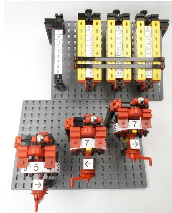
Abb. 18: Zweiter Schritt in der verkürzten Multiplikation von 1,56 mit 3,74
