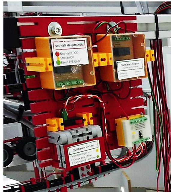
Abb. 11: Das Not-Halt-Panel ist ein eigenständiges, diskret aufgebautes Modul. Robuste Technik im Stil der 80er Jahre – nur nicht in grau. Das Hauptschütz links oben signalisiert den Zustand mit internen LEDs. Diese Information ist failsafe überall auf der Strecke abrufbar.
