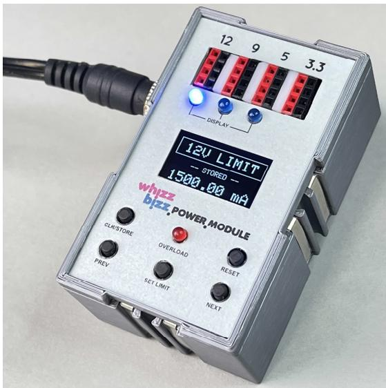
Abb. 1: Das „erweiterte“ Modul mit Display und vier Ausgangsspannungen
