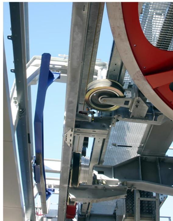
*Abb. 6: Spurrolle in der Original-Anlage*
