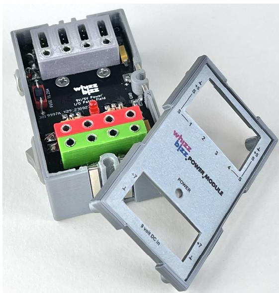
Abb. 8: Stromversorgungsmodul mit 2,6 mm fischertechnik-Buchsen
