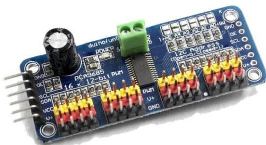
Abb. 9: Adafruit PCA9685 16-Kanal-Servo-Treiber
