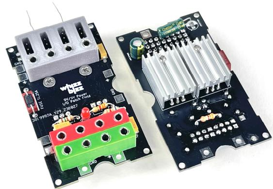
Abb. 6: Vorder- und Rückseite der Leiterplatte zur Montage im 3D-gedruckten Gehäuse
