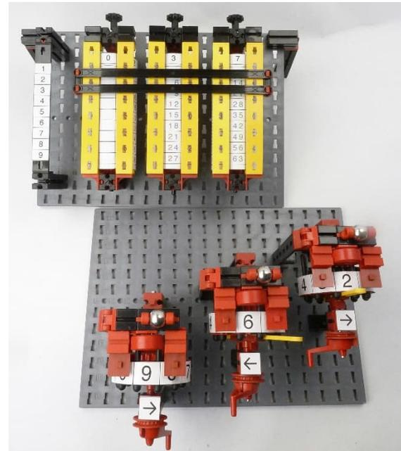
Abb. 16: Mit versetzten Walzen berechnet man das Produkt  $26 \cdot 37$
