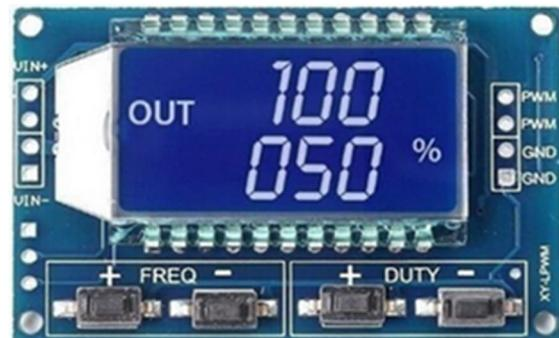
Abb. 11: PWM-Signalgenerator
