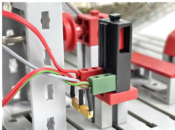
Abb. 2: Drucktaster mit Kondensatoren
