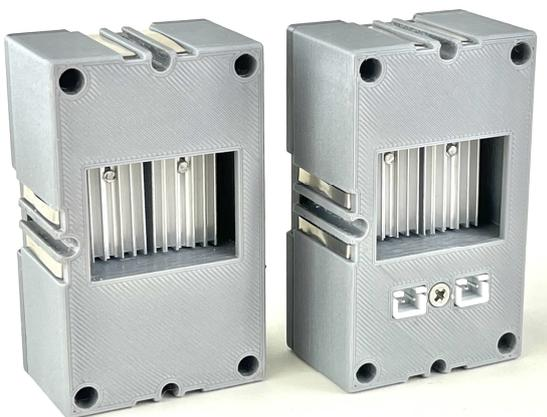
Abb. 3: Rückseite mit Öffnung für Kühlkörper und optionaler Durchschleifmöglichkeit
