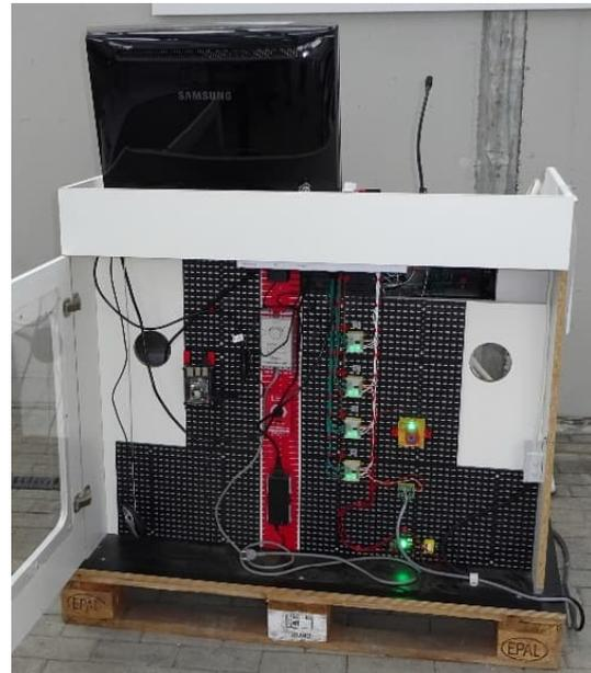
Abb. 5: Das Doppelmayr-Steuerpult ist an vier Controller angeschlossen
