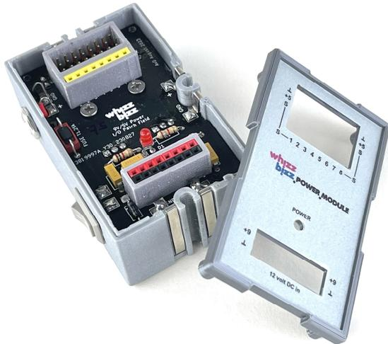
Abb. 7: Netzteilmodul mit Dupont-Headerleisten
