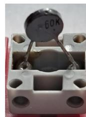
Abb. 3: ft-NTC-Temperatursensor
