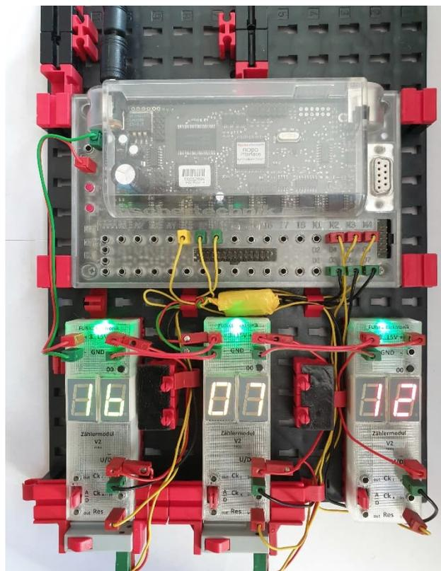
Abb. 6: Das Uhrenmodell am Controller (LED-Anzeige grün – gelb – rot für Std. – Min. – Sek.)
