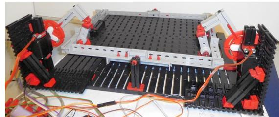
Abb. 8: Tilt-Plattform mit Servo-Aktoren
