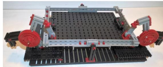
Abb. 4: Tilt-Plattform mit Kugelgelenken aus dem 3D-Drucker
