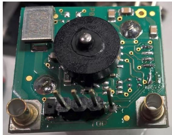
Abb. 5: Platine mit eingelötetem Pin für den zusätzlichen Ausgang und Brücke, die das Signal des Sensors herausführt
