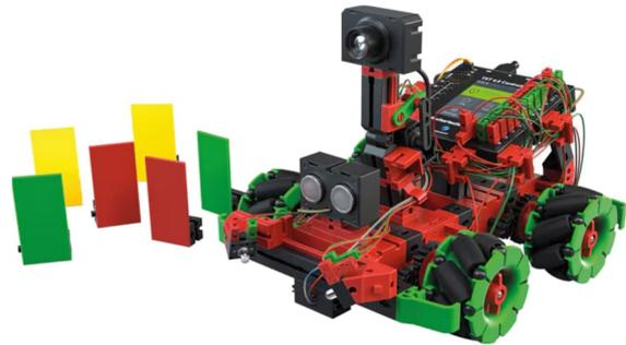
Abb. 16: Omniwheels-Fahrzeug mit Sensoren
