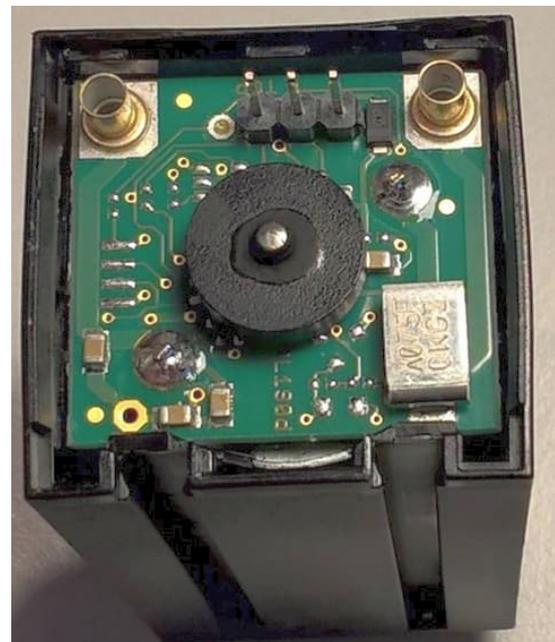
Abb. 1: Geöffneter fischertechnik-Encodermotor „Competition“ (186175)
