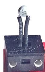
Abb. 7: NTC-Temperatursensor
