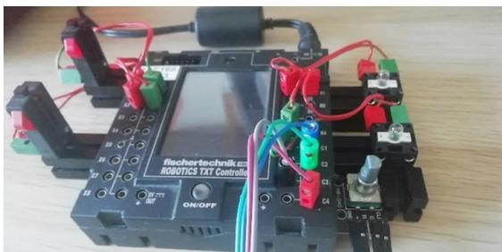
Abb. 5: Anschluss des KY-040 an den TXT
