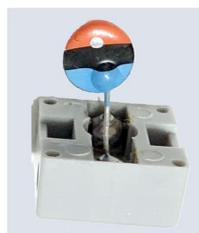
Abb. 2: ft-NTC-Temperatursensor
