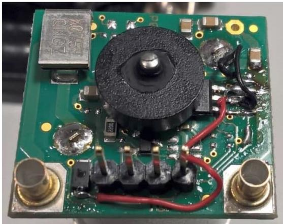
Abb. 6: Fertig installierter Hall-Sensor mit Leitungen für die Versorgungsspannung: rot: VCC, schwarz: GND.
