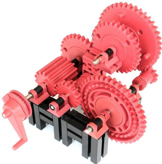
Abb. 14: Datumsanzeige – Übersetzung 31:1 mit „historischem“ fischertechnik-Differential
