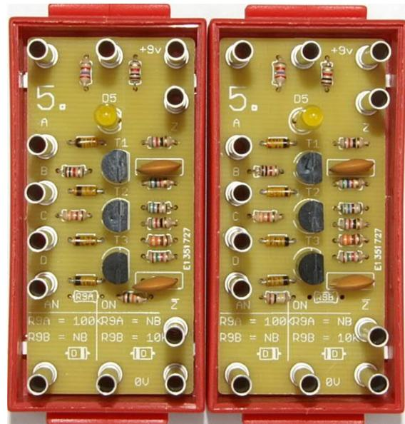
Abb. 207: Nachbau 4: Beide Platinen im 30×60-Gehäuse
