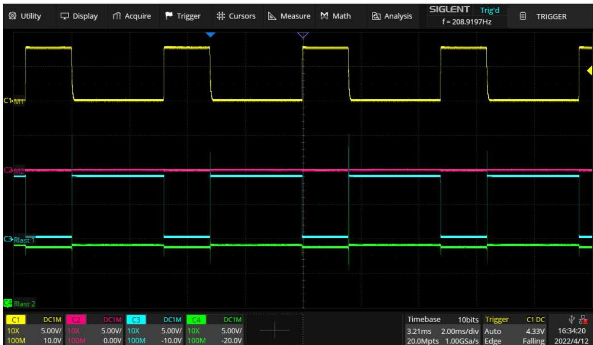
Abb. 7: PWM links; M1 aktiv und M2 auf GND
