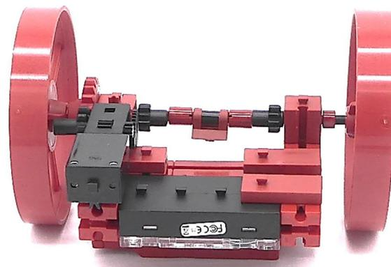
*Abb. 7: Fernsteuerung hinzugefügt*
