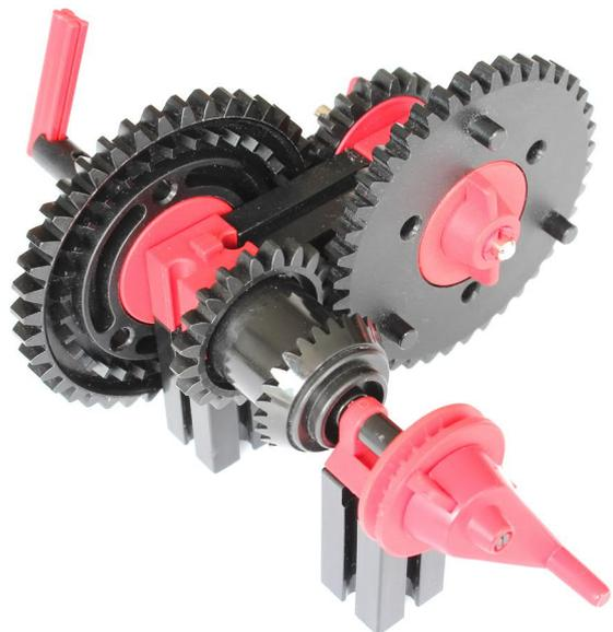
Abb. 13: Wochentaganzeige – Übersetzung 7:1 mit fischertechnik-Rast-Differential
