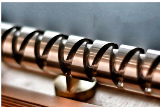
Abb. 6: Kreuzgewindespindel mit Gleitstein
