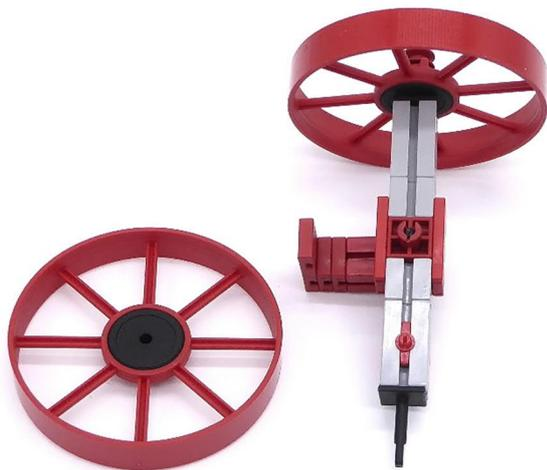
Abb. 16: Die Vorderachse von unten
