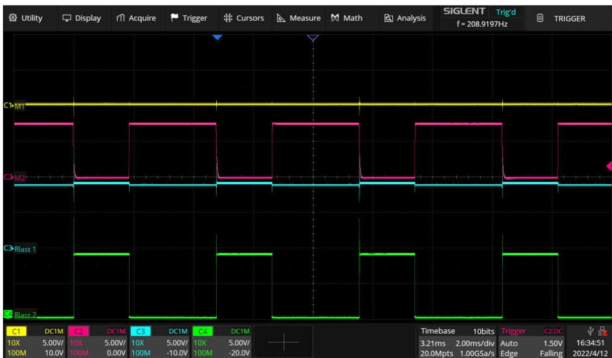
Abb. 8: PWM rechts; M2 aktiv und M1 auf GND
