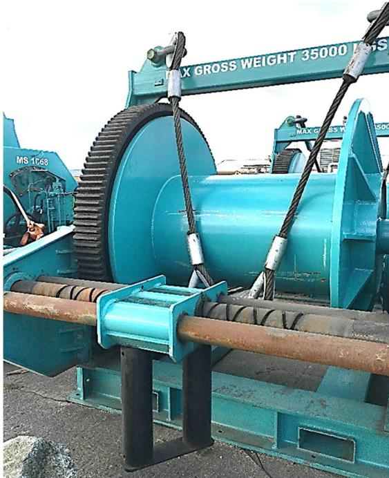
Abb. 7: Seilführung einer Kreuzgewindespindel bei einer Schwerlastwinde (mit freundlicher Genehmigung der Fa. Bornemann Gewindetechnik)
