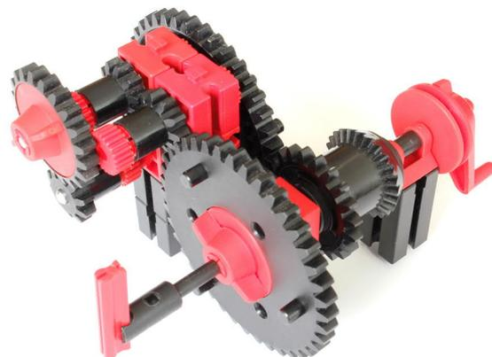
Abb. 17: Datumsanzeige – Übersetzung 31:1 mit fischertechnik-Rast-Differential
