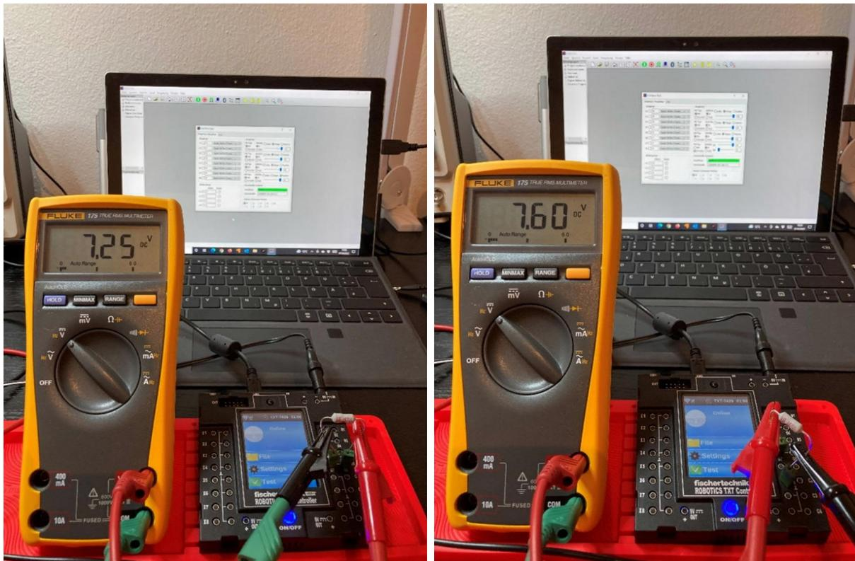
Abb. 1: Spannung am TXT bei 100  $\Omega$  Last am Motorausgang (links) bzw. am Einzelausgang (rechts)
