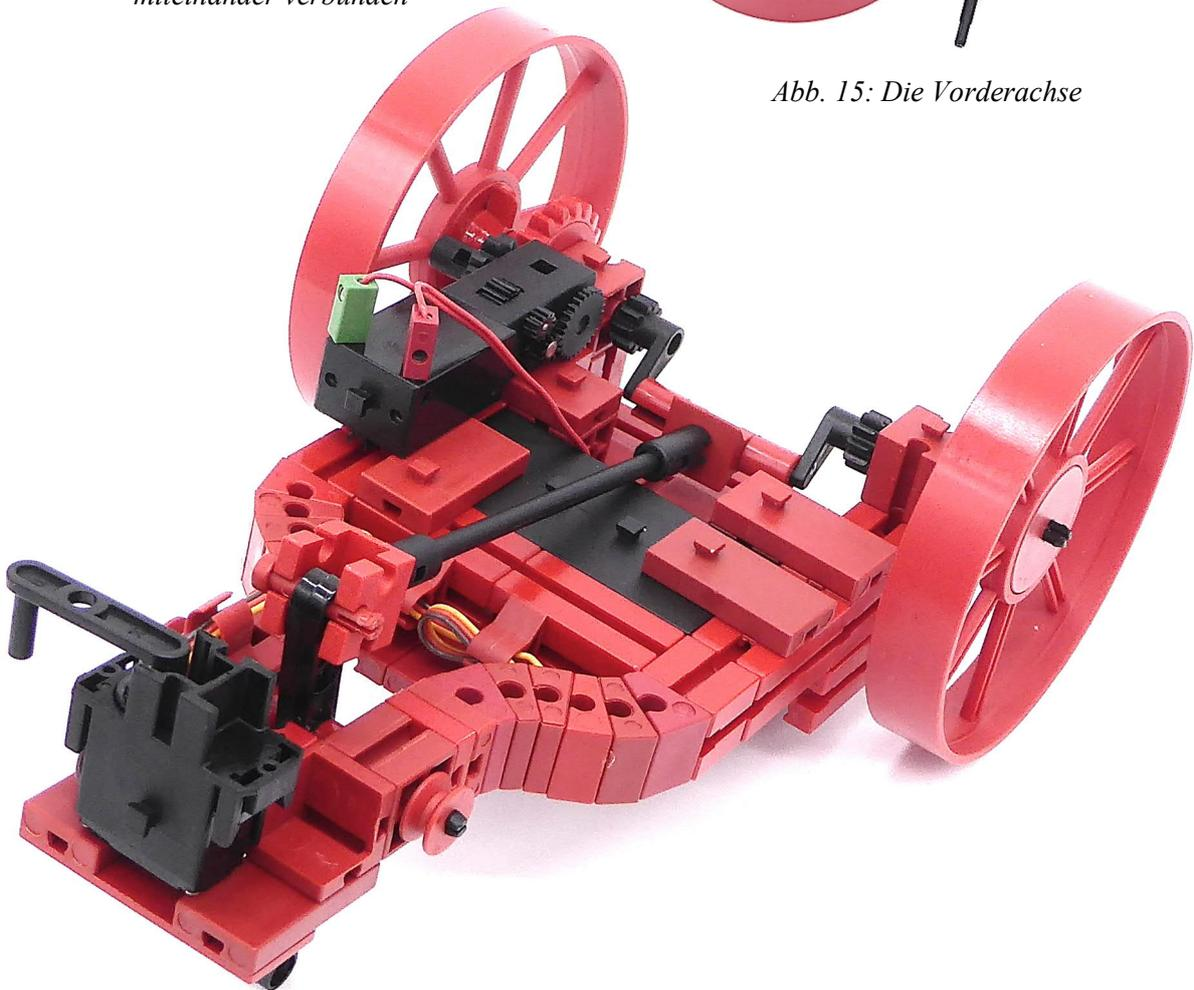
*Abb. 14: Das eingebaute Antriebsgestänge von unten*
