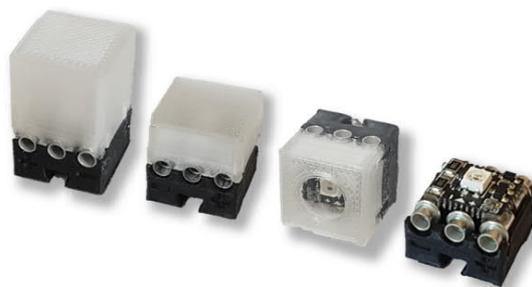
Abb. 4: ftPixel in der XL-, Standard- und Scheinwerfervariante. Rechts außen ohne Abdeckung
