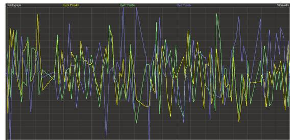
Abb. 11: Rauschen des Gyro-Sensors ohne Filterung [Skala: 0,1s/0,001°/s]
