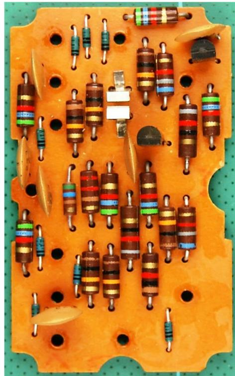
Abb. 138: Platine des Flip-Flops
