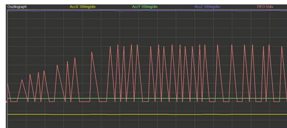
Abb. 9: Volllaufen des FIFO-Puffers (rot: Anzahl Messwerte im Puffer [Skala: 0,1s/5])
