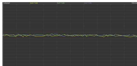
Abb. 12: Filter-Mode 2: Sensor-Werte mit Decimation Filter 2 [Skala: 0,1s/0,001°/s]
