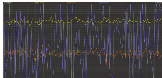
Abb. 18: Rauschen der ungefilterten Rohdaten [Skala: 0,5s/1 $\mu\text{T}$  bzw. 10 $\mu\text{T}$  (Z-Achse)]
