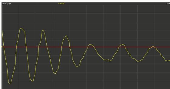
Abb. 11: Mit  $K_p = 0,9$  beginnt der P-Regler zu oszillieren [Skala: 1s/25]
