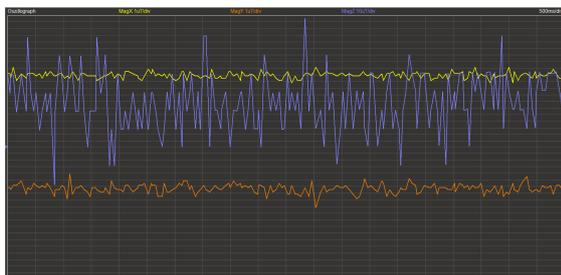
Abb. 19: Rauschen im Regular Mode [Skala:  $0,5s/1\mu T$  bzw.  $10\mu T$  (Z-Achse)]
