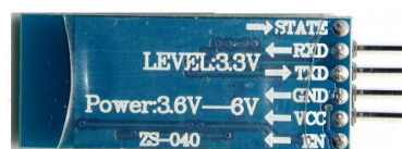
Abbildung 6.61: Anschlüsse des HC-06
