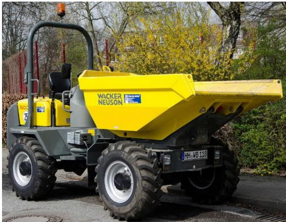
*Abb. 1: Dumper mit Allradantrieb
