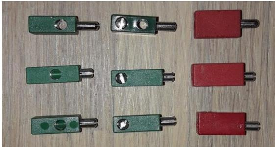
Abb. 6: Vergleich der fischertechnik-Steckergenerationen (Robin [3])
