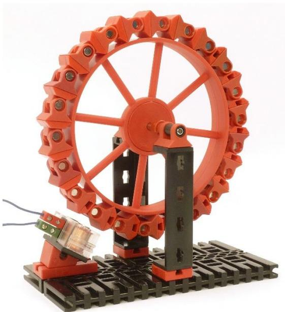
Abb. 5: Synchronmotor aus 22 Gelenksteinen mit einer Drehzahl von ca. 273 U/min.
