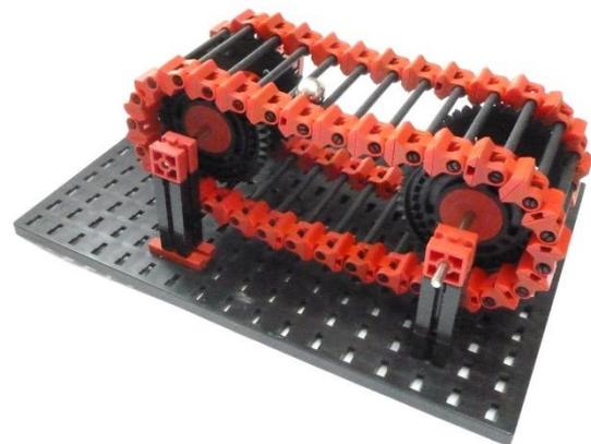
Abb. 3: Förderband zum Kugeltransport.
