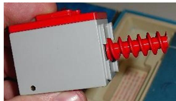
Abb. 6: Die Schnecke hatte keine Aufnahme für die [Antriebsfeder](#) und keinen Zahnkranz mit feinen Zähnen
