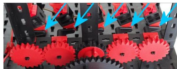
Abb. 12: Ausrichten der Rastkurbeln
