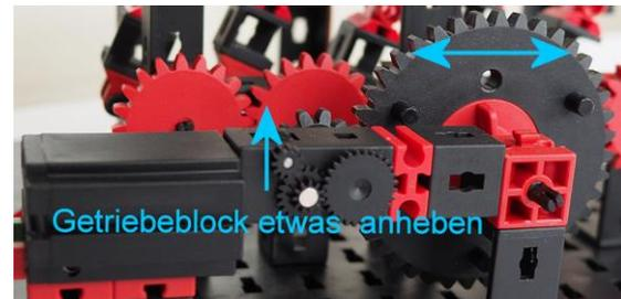
Abb. 9: Motor für Handbetrieb entkoppeln
