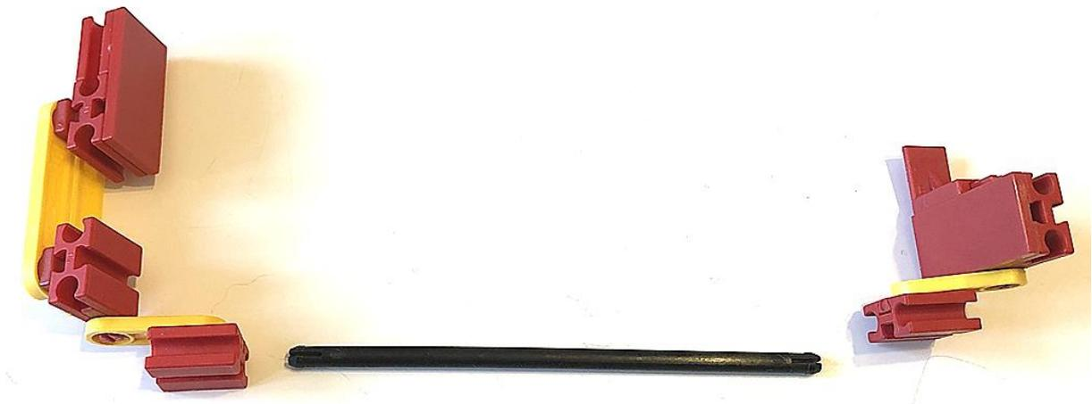
Abb. 14: Der Aufbau der Fußschaltermechanik
