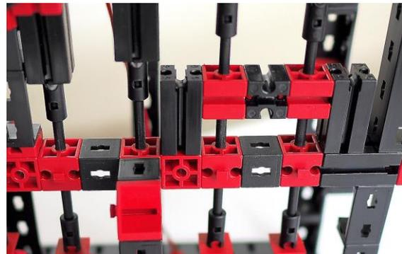
Abb. 14: Bessere Führung der langen Achsen
