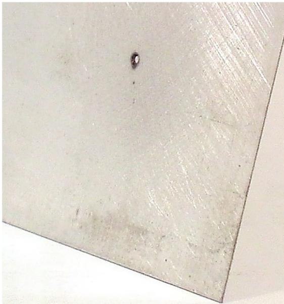
*Abb. 7: Loch auf der Bohrseite nach der Reinigung*
