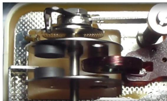
Abb. 19: Elektrisch angetriebene Unruh
