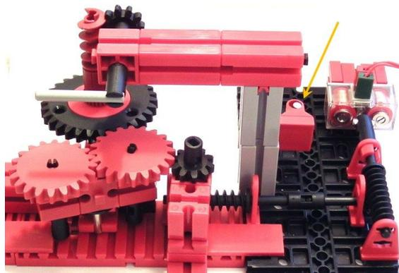
Abb. 27: Selbst anlaufender Synchronmotor
