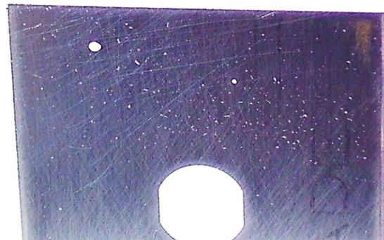
Abb. 5: Die ersten Löcher, Durchmesser etwa 0,6 und 0,2 mm
