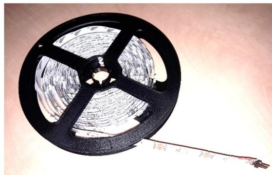
Abb. 2: Eine Rolle mit LED-Band
