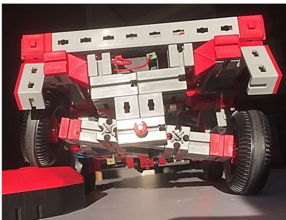
*Abb. 11: Pendelachse*
