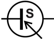
Abb. 5: ISO-Symbol für Schaltnetzteil
