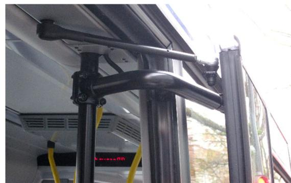
*Abb. 14: Außenschwenktür eines Busses. Gut zu erkennen ist, wie der gewinkelte Traglenker um die Gegenschließkante herumreicht. Ebenfalls sichtbar ist der Führungslenker.*
