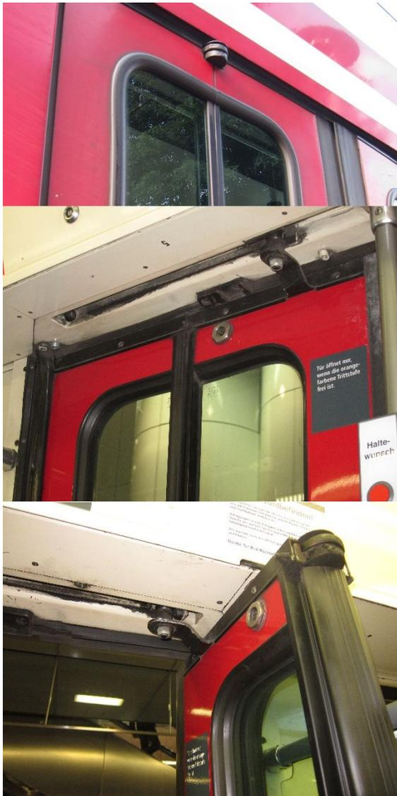
Abb. 20: Falttür einer U-Bahn: oben: außenliegendes Gelenk; unten: die ‚losen‘ Türblätter werden durch eine Schiene geführt, aber nicht getragen, die Flügel sind freitragend. Die vertikalen Nebenschließkanten der Türblätter sind durch Gummiwülste geschützt (Quetschgefahr).
