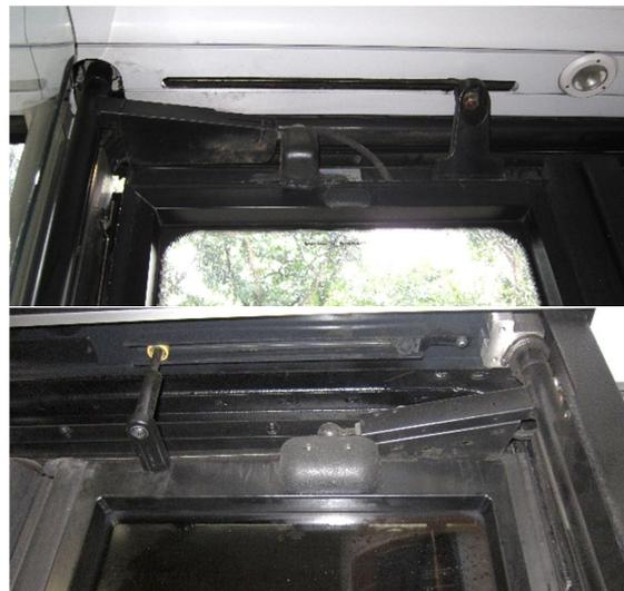
Abb. 9: Innenschwenktür eines Busses. Im unteren Bild ist deutlich sichtbar, dass die Rolle des Schwenkschiebelagers nur geführt wird und keine Last trägt.
