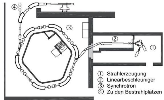
Abb. 2: Der Ionenbeschleuniger HIT [2]
