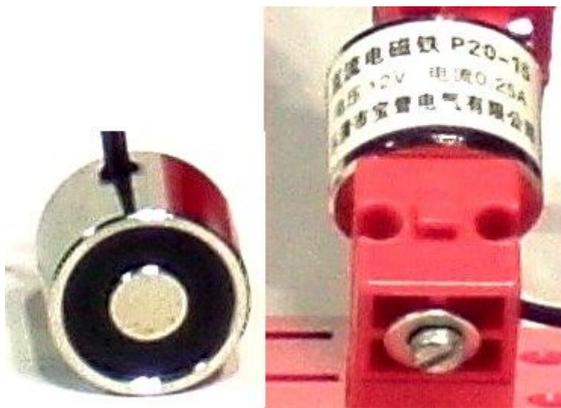
Abb. 4: Mein Topfmagnet von vorne und mit Befestigung hinten
