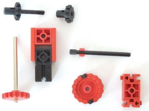
Abb. 9: Komponenten des Getriebes
