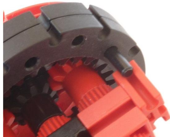
Abb. 13: Mitnahme zwischen Steg und Innenzahnradern im normalen Gang
