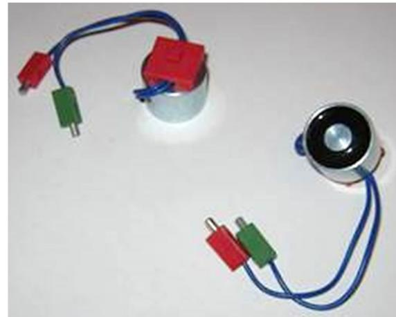
Abb. 5: Elektromagnete zur Nutzung mit fischertechnik
