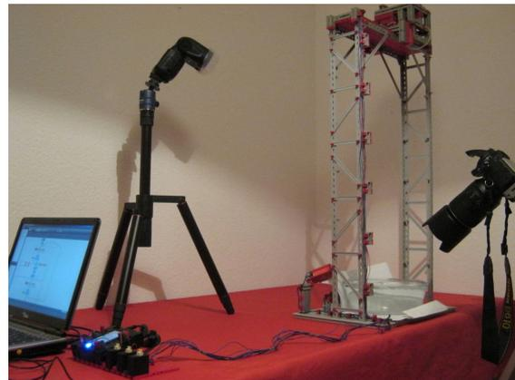
Abb. 1: Gesamtaufbau zur Aufnahme von Tropfen, die in eine mit Wasser gefüllte Schale fallen
