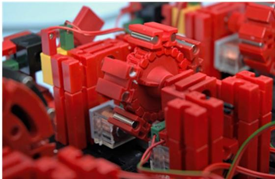
Abb. 4: Jeweils drei „normale“ und ein „Förderglied“ 37192 multipliziert mit fünf passen genau auf ein Zahnrad mit 20 Zähnen.
