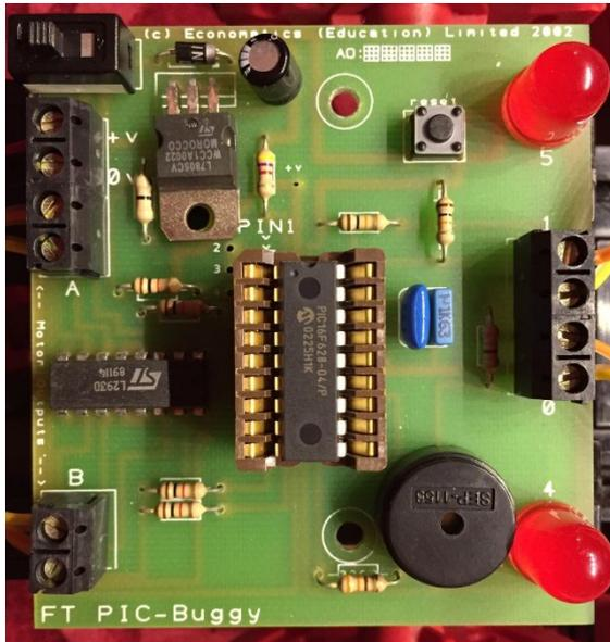
Abb. 5: Oberseite der Platine des ft-PIC-Buggy mit PIC 16F628 und L293D Motor-treiber-IC, Ausgangsklemmen für zwei Motoren, zwei LEDs, ein Piezo-Lautsprecher und Eingangsklemmen für die Taster zur Hinderniserkennung
