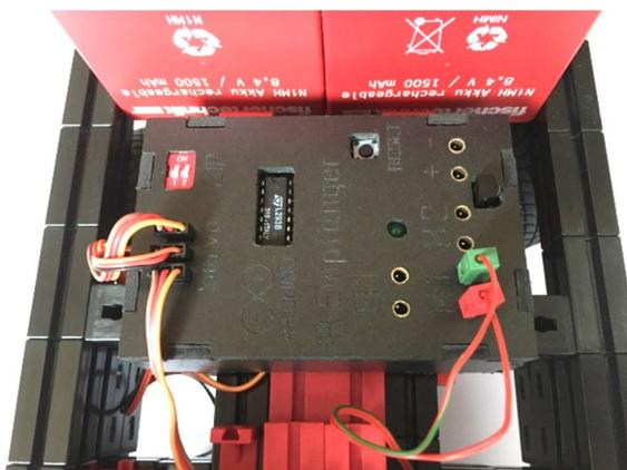
Abb. 11: Der IR-Empfänger im Einsatz
