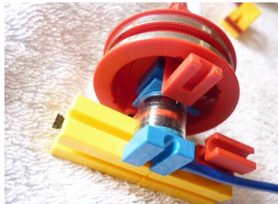
Abb. 4: Drehdurchführung am Schleifring
