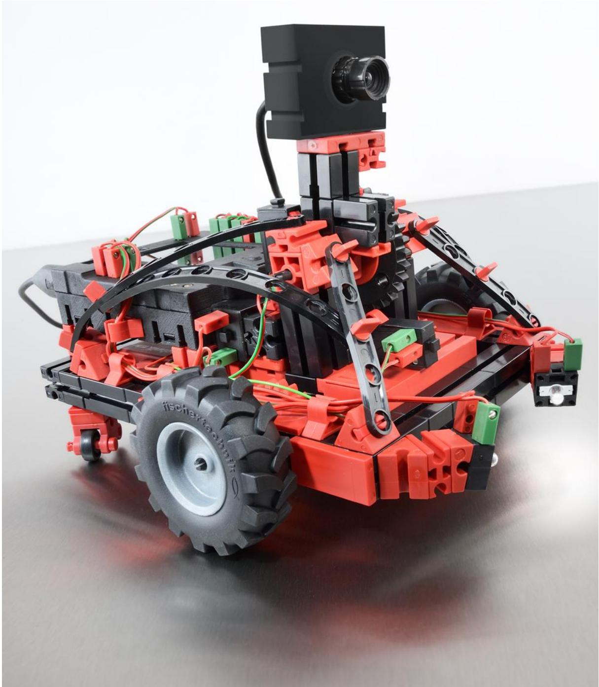
*Roboter mit neuem TXT-Controller und Kamera*
