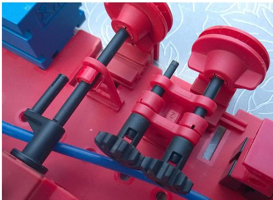
Abb. 4: Zählwerk mit Zehner-Übertrag
