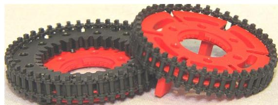
Abb. 3: Z46 (aus Innenzahnrad) und Z42 (aus Drehscheibe 60)
