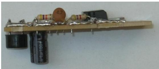
Abb. 3: Schaltungsaufbau zum Betrieb des Druckmessumformers Motorola MPX5100
