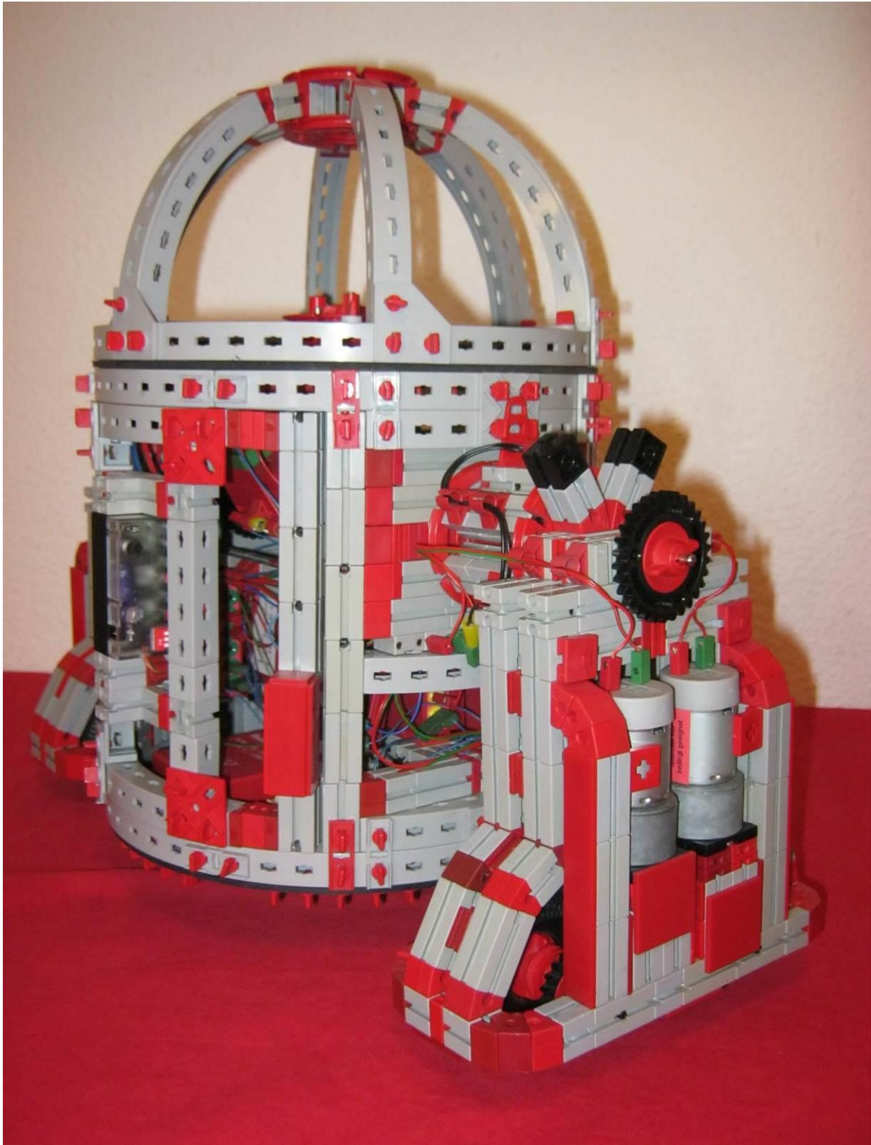
*Abb. 8: Radsatz mit zwei Motoren (vorne rechts)*
