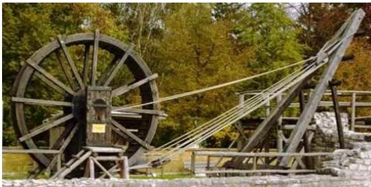
Abb. 17: Römischer Baukran mit Tretrad (Limesmuseum bei Aalen)
