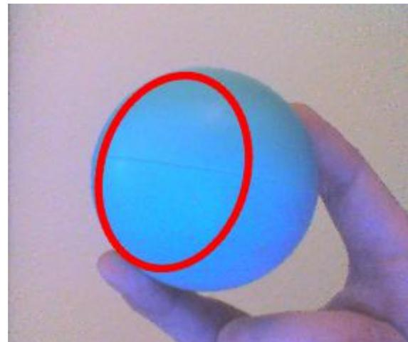
Abb. 7: OpenCVs Camshift hat den Ball im Bild lokalisiert
