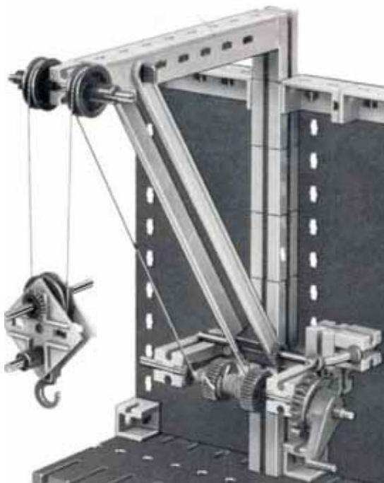
Abb. 14: Differentialwinde
