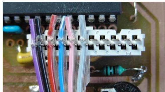
Abb. 4: Auflegen des sechspoligen Flachbandkabels am PORT A des Mikrocontrollers
