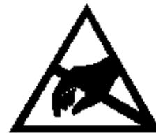
Abb.1: Warnhinweis zum Schutz vor elektrostatischer Aufladung
