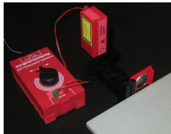
Abb. 8: Linienlasereinheit mit Spannungsquelle und zu vermessender Linse
