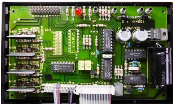
Abb. 1: Geöffnetes ft-Universal-Interface 30520 für die parallele PC-Schnittstelle
