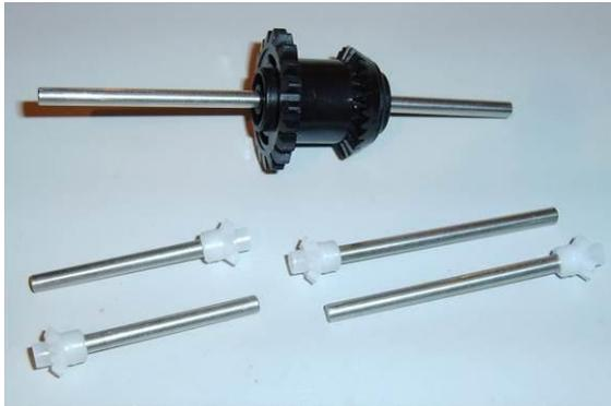
Abb. 4: Differentialkäfig mit Metallachsen
