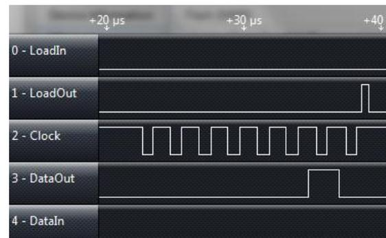
Abb. 5: Senden des Bytes 0x02 zum Einschalten von Motor 1
