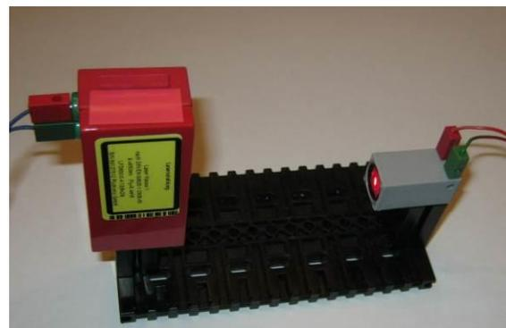
Abb. 11: Aufbau einer Laserlichtschranke (gezeigt sind nur wenige Zentimeter; mehrere Meter sind jedoch mühelos erreichbar, gegebenenfalls unter Nutzung einer Störlichtkappe)
