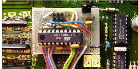
Abb. 13: In das Interface eingebautes Board
