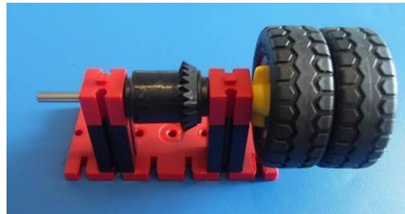
Abb. 6: Aufbau mit Zwillingbereifung, links mit 45 mm- und rechts mit 60 mm-Achse
