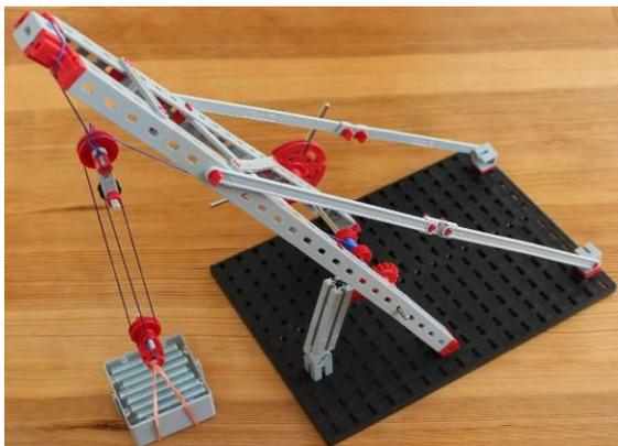
Abb. 3: fischertechnik-Modell eines Trispastos
