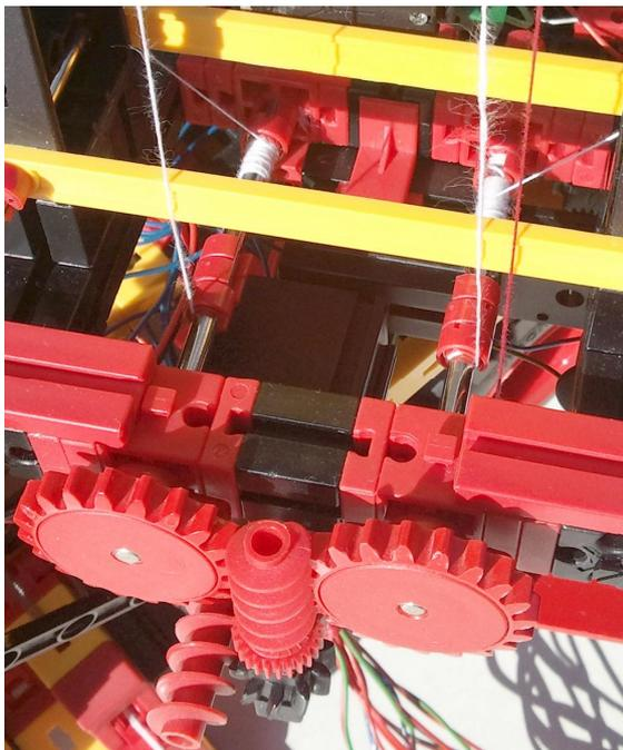
Abb. 6: Seilzug eines Teleskop-Arms des oben schon erwähnten [Mobilkrans](#)
