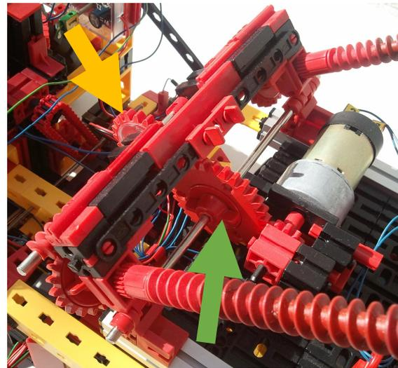
Abb. 4: Kranarm-Hebemechanik eines [Autokrans](#)
