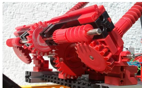
Abb. 5: Spätes Eintauschen von hoher Drehzahl gegen hohes Drehmoment und hohe Schiebekraft
