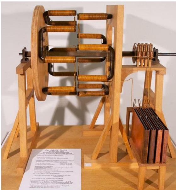
Abb. 5: Funktionsfähiger Nachbau des Jakobi-Motors am KIT: 160 U/min., 15 W [5]
