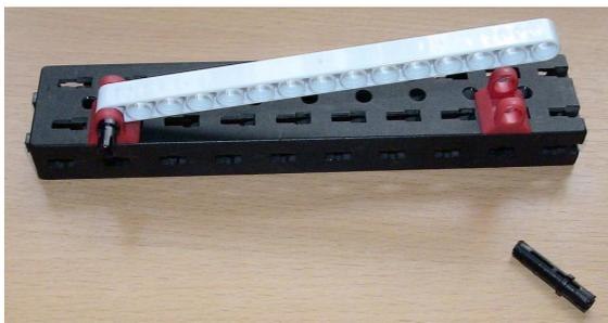
*Abb. 1: Mechanische Verbindung der Loch-Balken*
