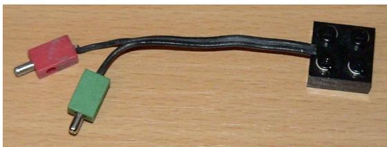
Abb. 8: Technic/RCX-Kabel mit Bananensteckern
