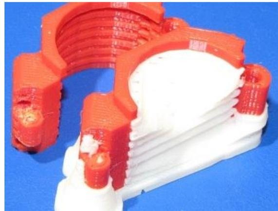
Abb. 6: Eine gedruckte Schleifring-Gehäusehälfte aus Abb. 4, mit und ohne Stützmaterial.
