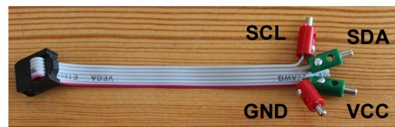
Abb. 3: Belegung des TX-Flachbandkabels
