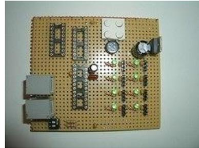
Abb. 19: Achtfach Sharp-IR-Mux
