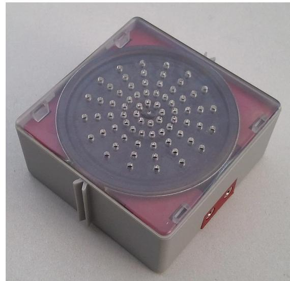
Abb. 26: Der Lautsprecher aus „Elektronik“
