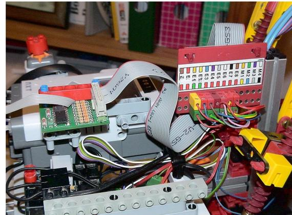
Abb. 22: Sieben fischertechnik-Taster an Buchsenplatte am PCF8574 Mux
