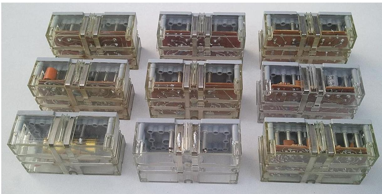
Abb. 16: Rückansicht der Silberlinge mit den handgelöteten Platinen
