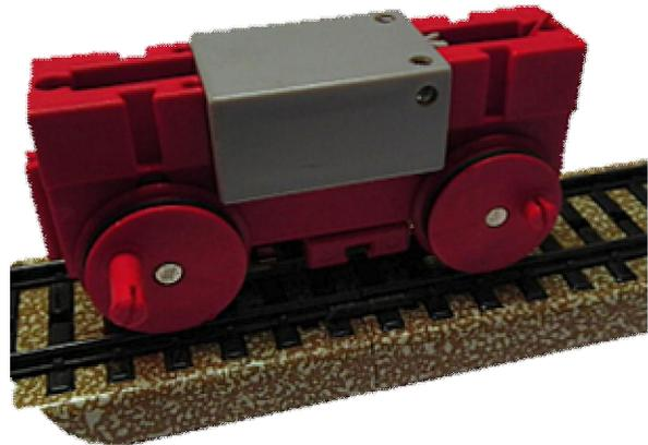
Abb. 6: Chassis mit Motor auf Märklin-Gleis
