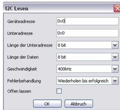
Abb. 5: Konfiguration des I<sup>2</sup>C-Read-Kommandos in Robo Pro
