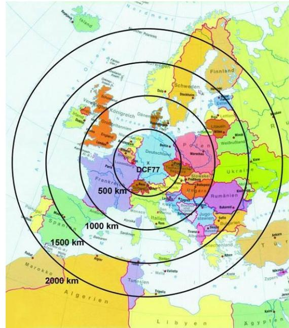
Abb. 1: Reichweite des DCF77<sup>1</sup>-Signals
