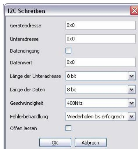
Abb. 4: Konfiguration des I<sup>2</sup>C-Write-Kommandos in Robo Pro
