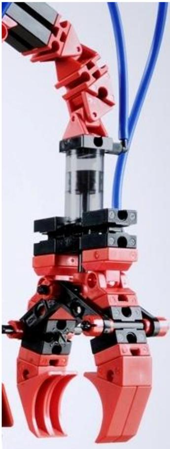
Abb. 19: Kardanisch aufgehängter Greifarm
