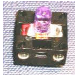
IR-LED mit antiparalleler Diode (als Sicherung gegen Falschpolung)
