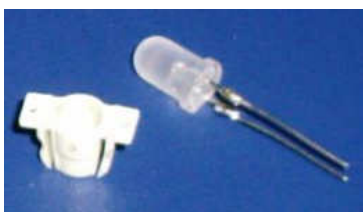
LED mit neuen Drähten (& entkernter FT-Fassung)
