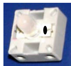
LED fertig (Kathode ist hier markiert)
