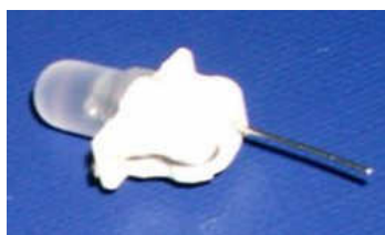
eingefaßte LED (eine Seite „eingefädelt“)
